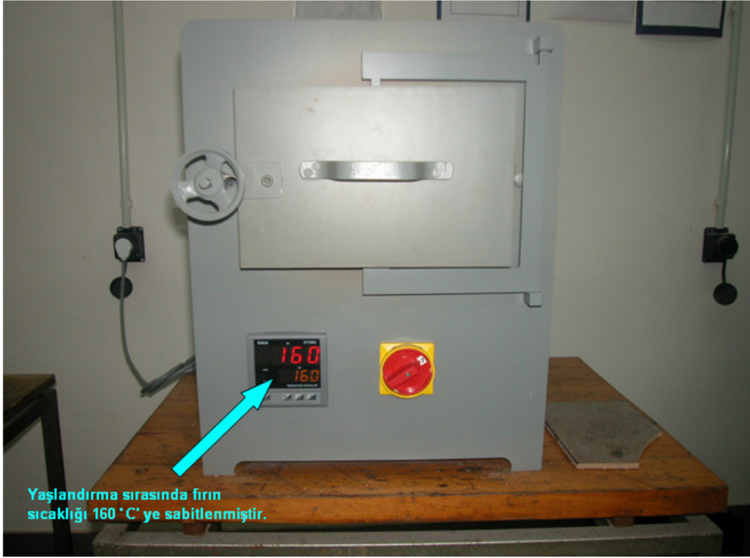
Şekil 5.23 Yaşlandırma prosesinin yapıldığı fırın.
