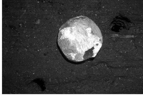
Şekil 5.7 Tekrar üretilen 45 µm takviye boyutuna sahip % 20 hacim oran takviyeli numune.
