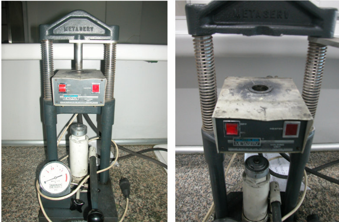
Şekil 5. 10 Sıcak montede kalıp için kullanılan ve ergiyik bakalite basınç uygulayan ekipman.
