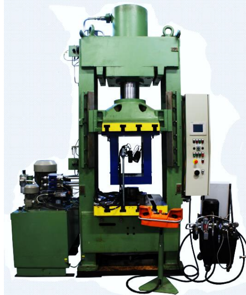
Şekil 3.11. Hidrolik pres CBA 300/63
