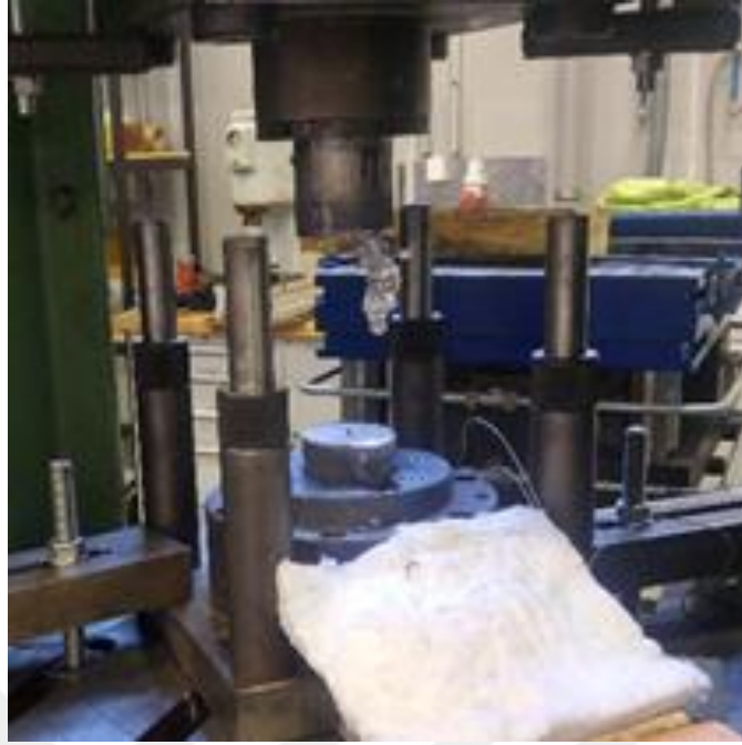
Şekil 3.14. Döküm parçasının katılaştıktan sonra kalıptan çıkarılması
