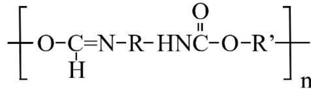
Şekil 1.16 : TPU'nun yapısal gösterimi.
