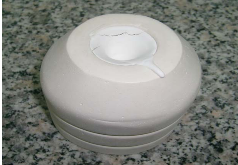
Şekil 3.13 \text{CA}_6(1) tozu ile yapılan slip döküm denemesi
