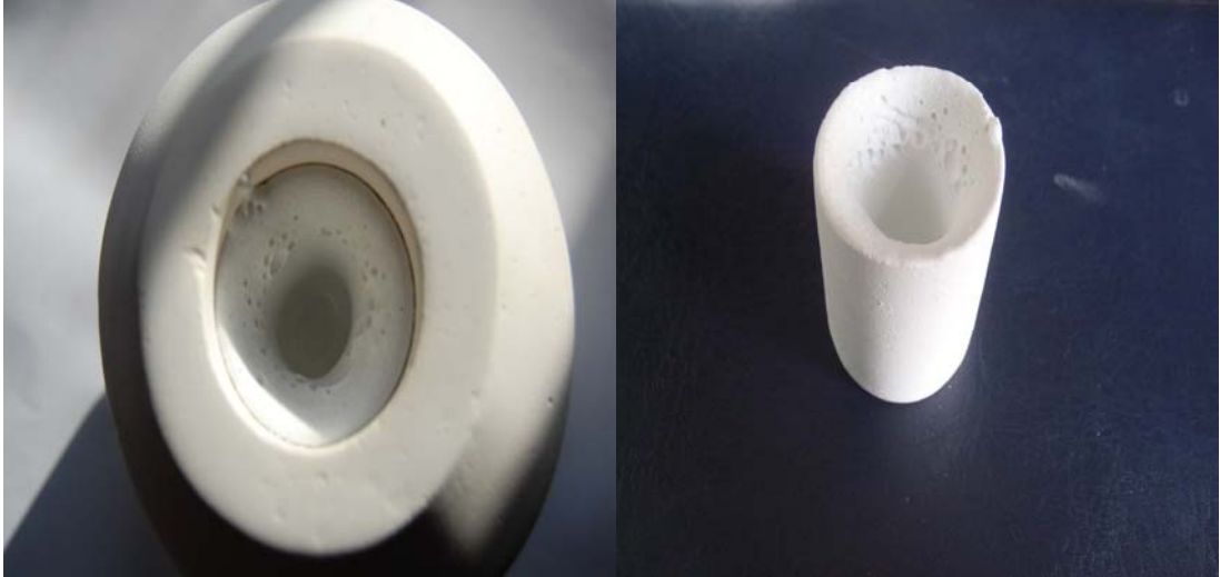
Şekil 3.16 Pota (B)'nin slip döküm çalışması
