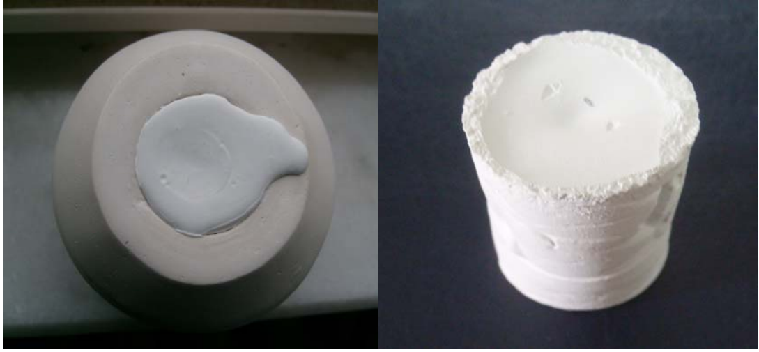
Şekil 3.14 CA 6 (2) tozu ile yapılan slip döküm denemesi
