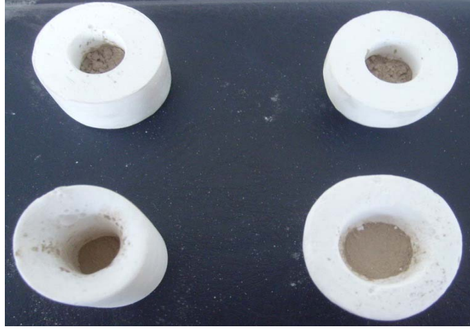
Şekil 3.21 İçerisine cruf yerleştirilmiş potalar
