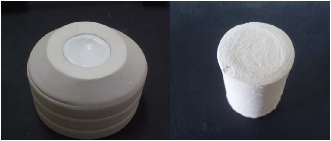
Şekil 3.15 (a) Pota (A)'nın slip döküm çalışması
