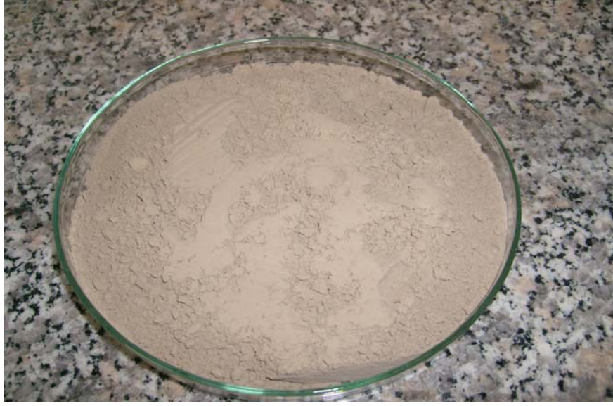
Şekil 4.19 İsdemir Yüksek Fırın Crufu (-63 µm)
