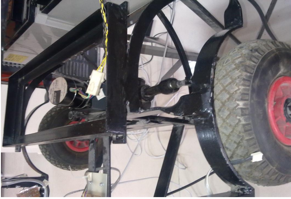
Şekil 2.4. Redüktörlü adım motoru ve araç dönüş sistemi
