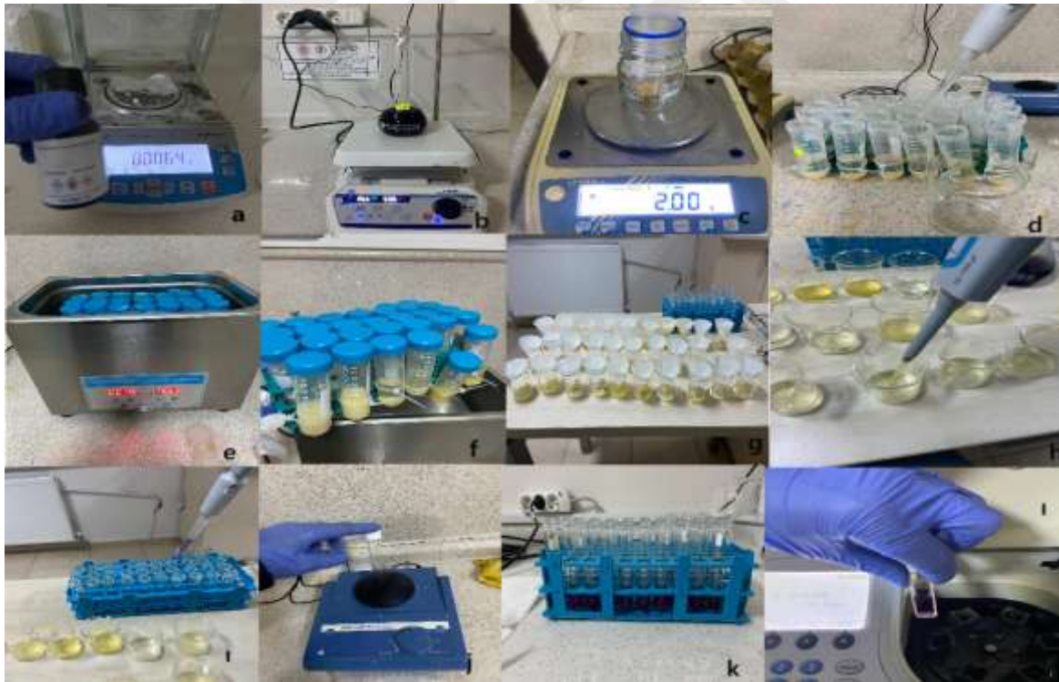
Resim 3.14. DPPH radikal giderim aktivite analizi (a-b: DPPH çözeltisinin hazırlanması, c: Yumurta numunelerinin tartılması, d: Numunelerin üzerine metil alkol ilavesi e: Ultrasonik-destekli ekstraksiyon, f: Elde edilen ekstratlar, g: Whatmann ile süzme işlemi, h: Süzüntülerden cam tüplere örnek alınması, i: DPPH ilavesi, j: Numunelerin homojenize edilmesi, k: İnkübasyon sonrası numuneler, l: Absorbansların spektrofotometre ile ölçülmesi
