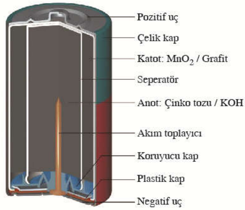
Şekil 2.10. Alkalın pilin yapısı
