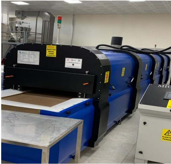
Şekil 2-7: Jeotermal enerji ile sebze meyve kurutma
