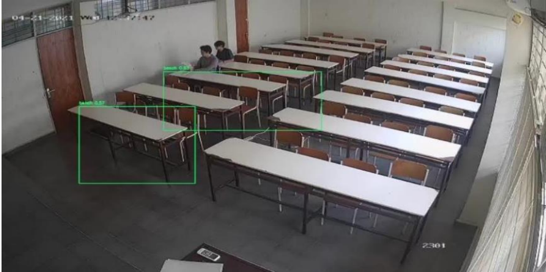
Şekil 9. Faster R-CNN ile Bir Sınırlayıcı Kutu Çizerek Kopyasız Normal Durumu Belirleme
