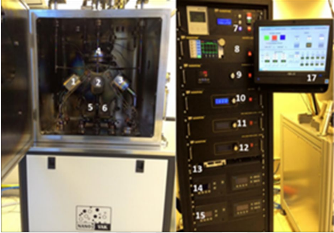
Resim 5.2. Nanovak NVTS-500 Eş-Püskürtme Sistemi [ (1) Saçtırma Kaynağı (RF), (2) Saçtırma Kaynağı (DC), (3) Saçtırma Kaynağı (RF2), (4) Isıtıcılı Örnek Tutucu, (5) Isıl Buharlaştırma Kaynağı, (6) Vakum Kontrol Ünitesi, (7) Vakum Kontrol Ünitesi, (8) Kalınlık Kontrol Ünitesi, (9) Sıcaklık Kontrol Ünitesi, (10) Gaz Kontrol Ünitesi, (11) Isıl Buharlaştırma Güç Ünitesi (1), (12) Isıl Buharlaştırma Güç Ünitesi (2), (13) DC Güç Kaynağı Ünitesi, (14) RF1 Güç Kaynağı Ünitesi, (15) RF2 Güç Kaynağı Ünitesi, (16) Örnek Döndürme Motoru, (17) Kontrol Ünitesi Motoru]
