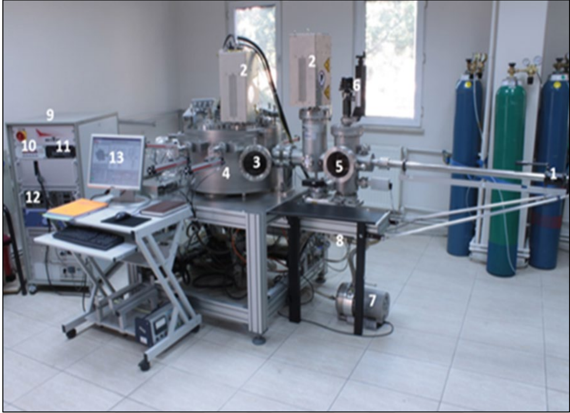
Resim 5.1. BesTec-Püskürtme Sistemi [ (1) Örnek Taşıyıcı Kol, (2) RF Saçtırma Kaynakları, (3) Plazma İzleme Penceresi, (4) Kaplama Odası, (5) Saçtırma İzleme Penceresi, (6) Gaz Balonları (Ar, O 2 , N 2 ), (7) Vakum Pompası, (8) Turbo Pompa, (9) Kontrol Ünitesi, (10) Vakum Gösterme Paneli, (11) Kalınlık Ölçer, (12) DC Besleme Jeneratörü, (13) Kontrol Ünitesi Monitörü]
