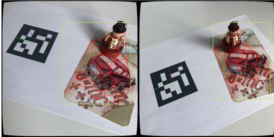
Görsel 3.14. 3 boyutlu sahne oluşturmada kullanılacak kaplama resimlerinin üçgen alanlarının sınır kutularıyla belirlenmesi
