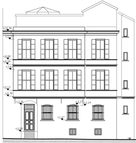
Şekil 5.22: Kuzeydoğu Cephesi Restitüsyon Çizimi (Yeteroğlu, 2013)
