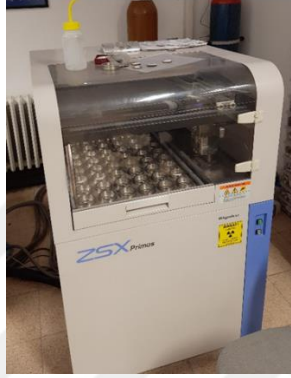
Şekil 2. 13. RİGAKU ZSX Primus XRF cihazı
