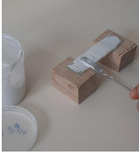
Şekil 2. 3. Karışımın cam yüzeyine uygulanması
