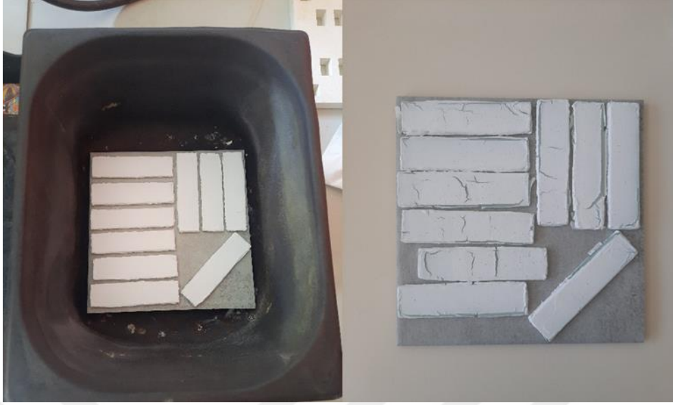
Şekil 3. 4. 450 °C'de 8 saat bekletilen 3 numaralı karışımla kaplanmış numuneler
