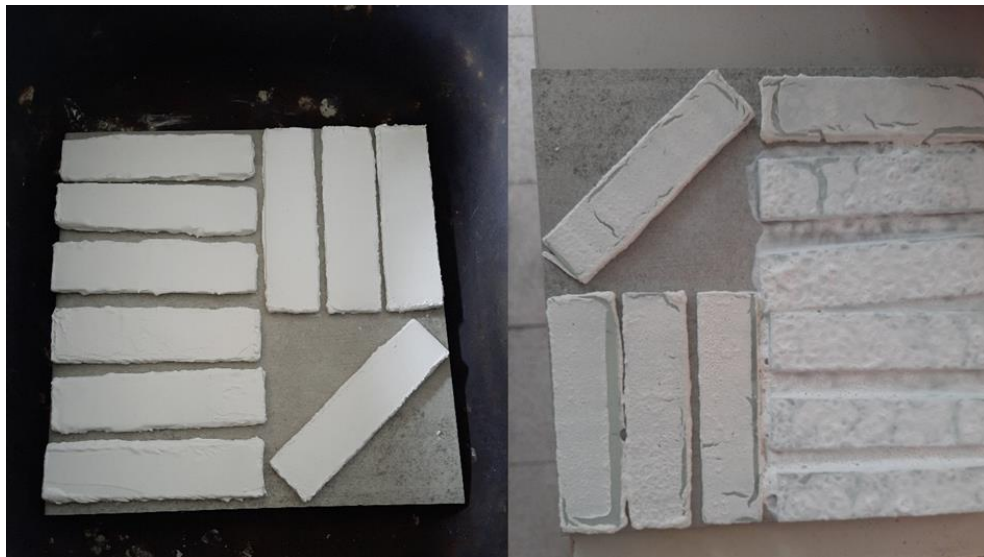
Şekil 3. 9. 450 °C'de 16 saat bekletilen 1 ve 2 numaralı karışımla kaplanmış numuneler
