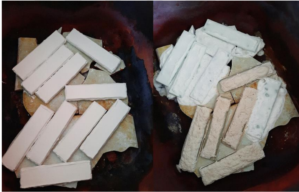
Şekil 3. 7. 450 °C'de 12 saat bekletilen 1 ve 2 numaralı karışımla kaplanmış numuneler
