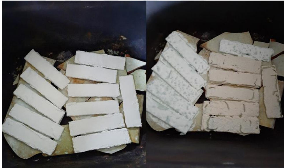
Şekil 3. 3. 450 °C'de 8 saat bekletilen 1 ve 2 numaralı karışım ile kaplanmış numuneler
