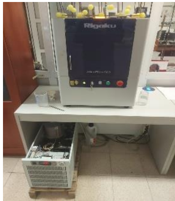
Şekil 2. 12. Rigaku MiniFlex 600 XRD cihazı
