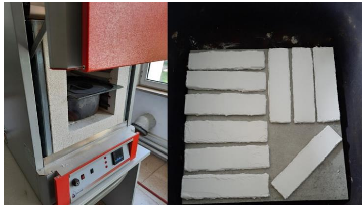
Şekil 2. 8. Karışımla kaplanan numunelerin fırına verilmesi
