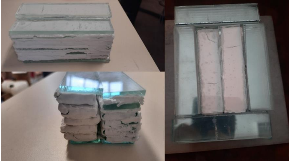
Şekil 3. 5. 450 °C'de 8 saat bekletilen 4 numaralı karışımla kaplanmış numuneler
