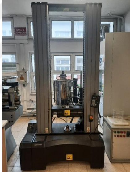
Şekil 2. 10. Instron 3 nokta eğme test cihazı
