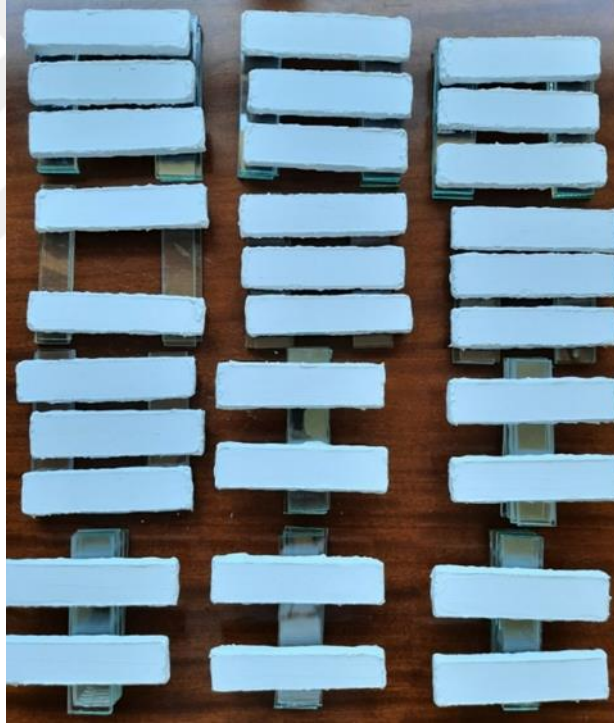
Şekil 2. 4. Yüzeyine karışım uygulanan numunelerin oda sıcaklığında kurumaya bırakılması
