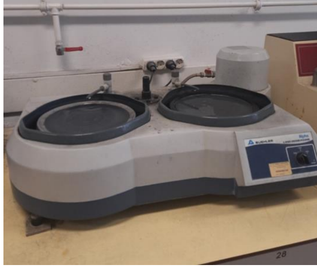
Şekil 2. 1. Buehler marka Alpha modeli parlatma cihazı
