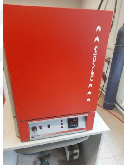
Şekil 2. 7. Kimyasal temperleme işleminin yapıldığı fırın
