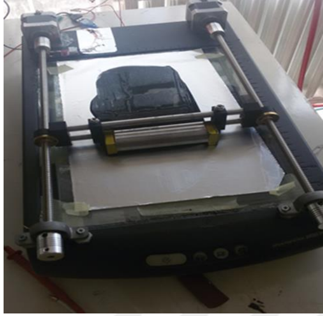
Şekil 2.2: Steper motor kontrollü serme cihazı.
