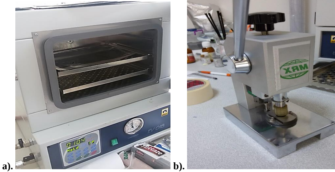
Şekil 2.3: a). Kurutma işlemlerinin yapıldığı etüv b). Katot kesme aleti.
