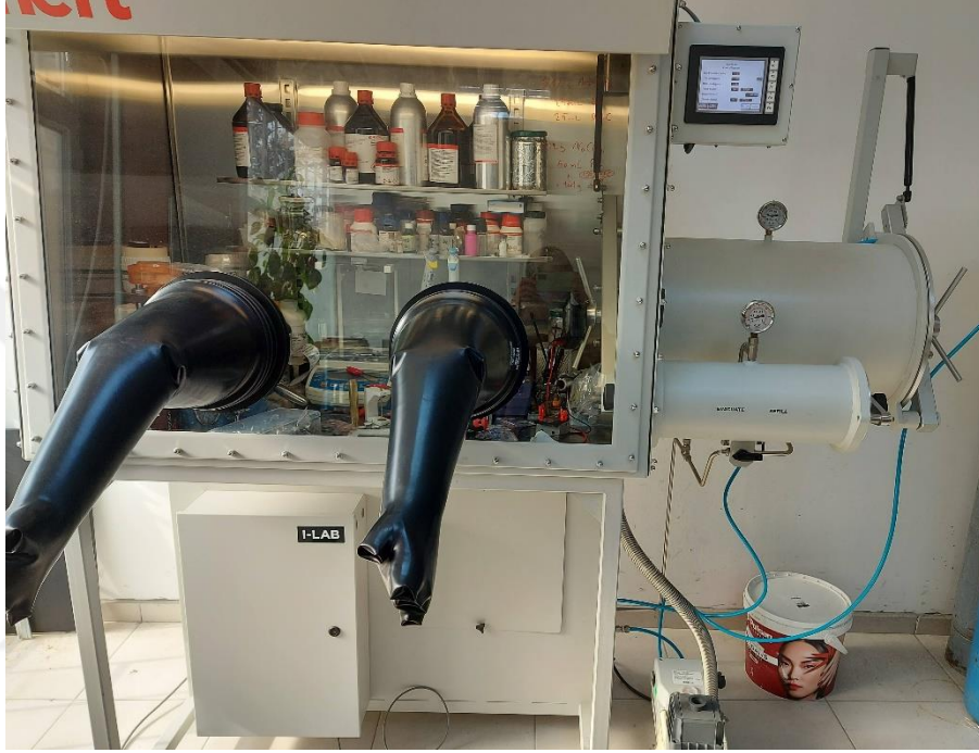
Őekil 2.4: Pil bileŐenlerinin bir araya getirilmesi iin gerekli ortamı saėlayan Glove-box.
