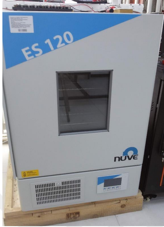
Şekil 2.7: Sıcaklığa bağlı Çevrim performans ölçümleri için kullanılan cihaz.
