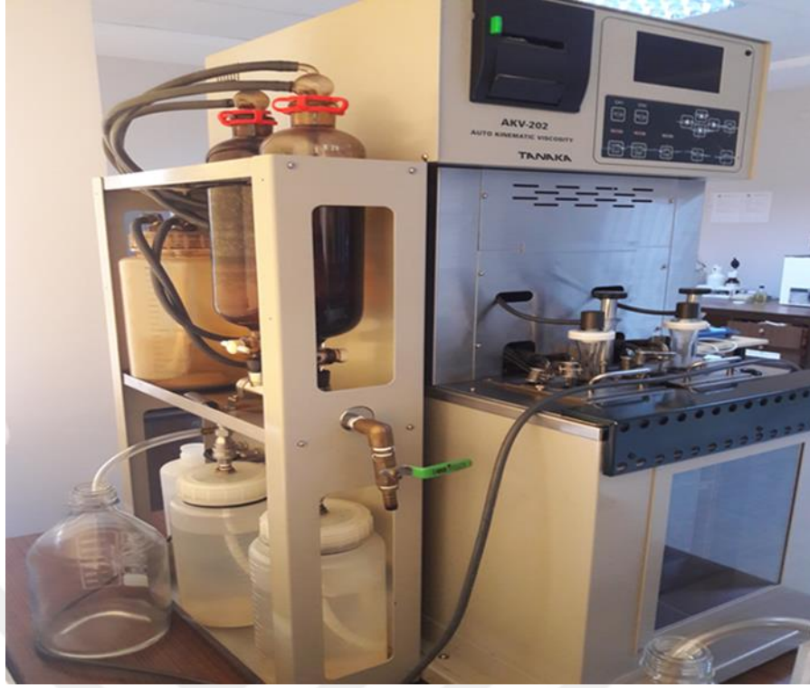
Şekil 4.9: Tanaka (AKV-202) otomatik kinematik viskozimetre ölçme cihazı
