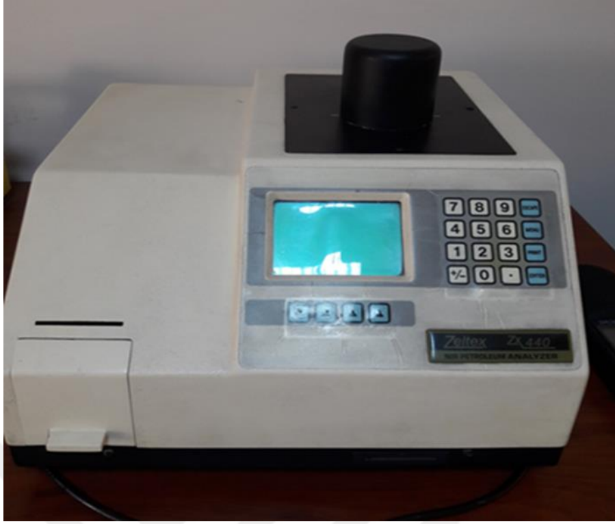
Şekil 4.11: Zeltex 16715 (ZX440) oktan sayısı ölçüm cihazı
