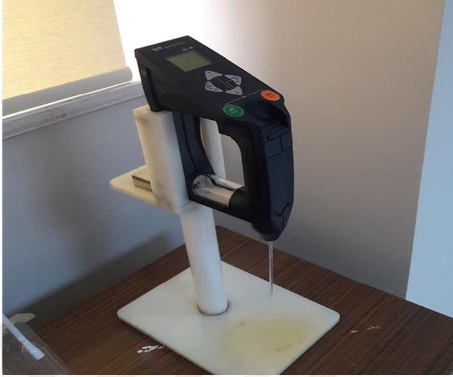
Şekil 4.8: Kyoto (Da-130) portatif dijital yoğunluk ölçme cihazı
