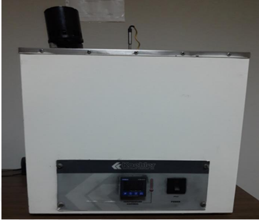
Şekil 4.10: Koehler (K25339) bakır şerit korozyon cihazı
