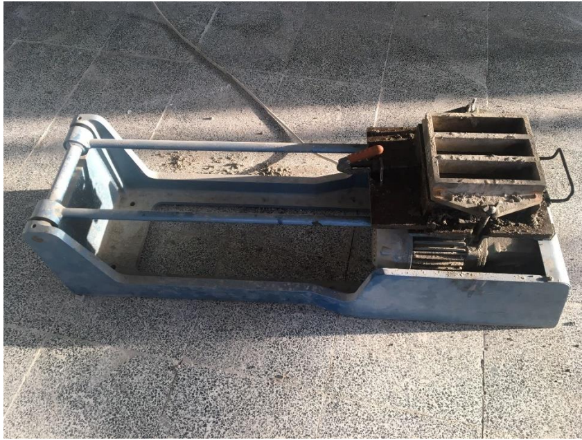
Şekil 13. Harç numunelerin kalıbına yerleştirilmesi
