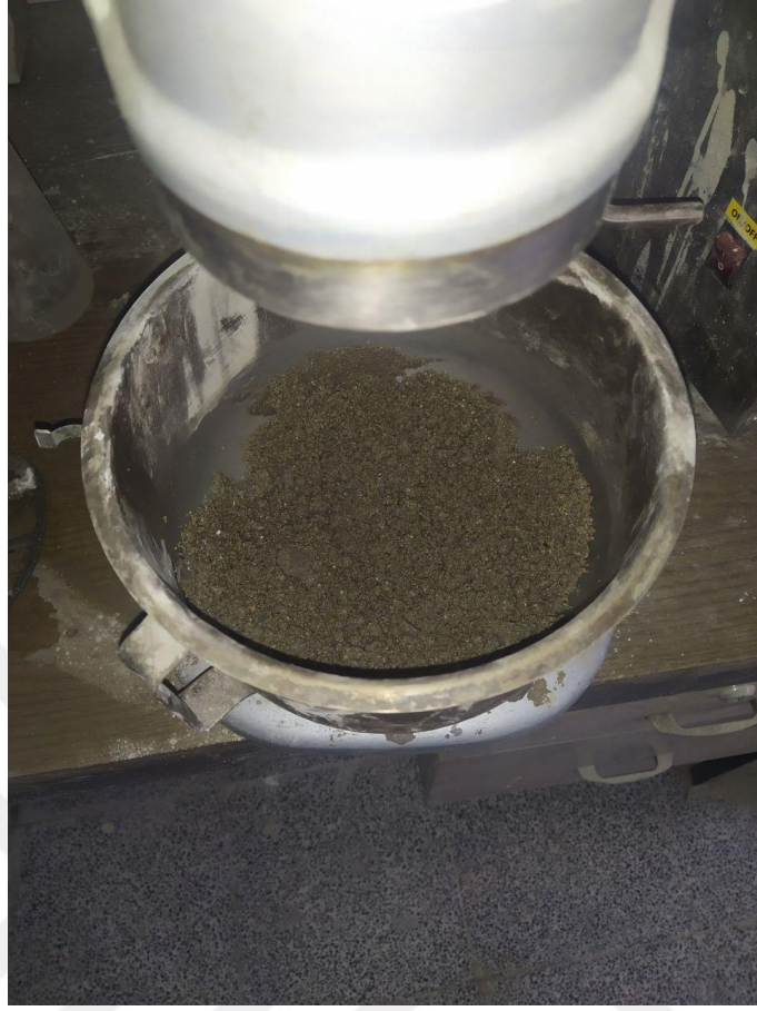
Şekil 12. Harç numunesinin mikserde karılması
