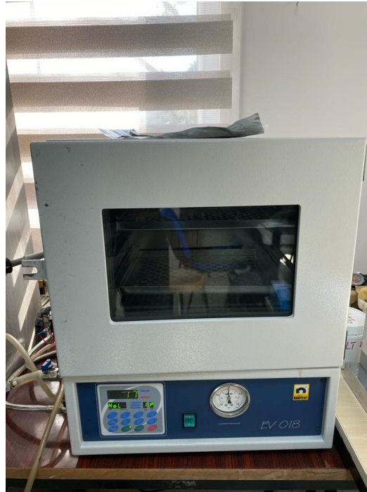
Şekil 2.20: Kaplanmış Al-folyoların etüvde kurutma işlemi
