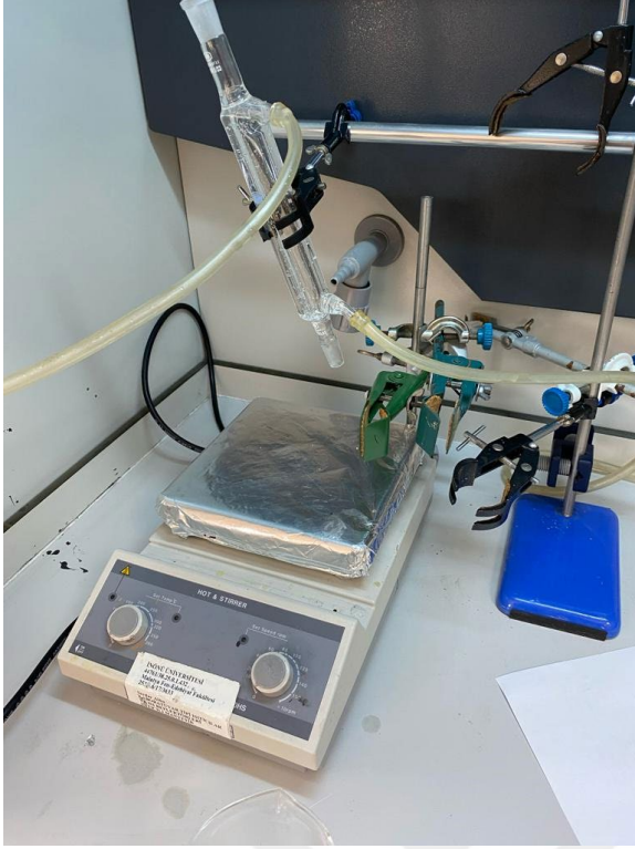
Şekil 2.18: NMP+PVDF+Carbon Black ve Aktif malzemenin manyetik karıştırıcıda hazırlanması
