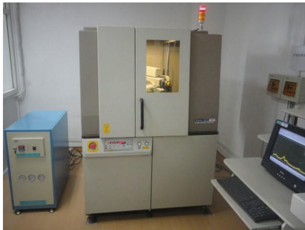
Şekil 4.3. X-ışınları difraktometresi (Rigaku D/MAX 2200).
