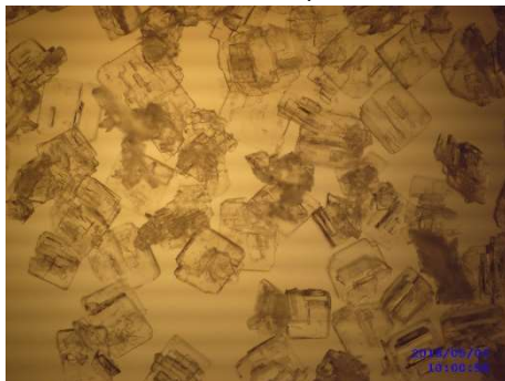
Şekil EK-1 1.26. MSMPR kristalizörde üretilen sodyum tetrafluoroborat kristallerinin mikroskop görüntüleri (sıcaklık: 80-30°C, debi: 52ml/dk., karıştırma hızı: 300 rpm, büyütme 32X, 1000 ppm borik asit katkılı)
