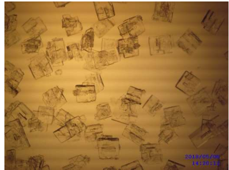
Şekil EK-1.5. MSMPR kristalizörde üretilen sodyum tetrafloroborat kristallerinin mikroskop görüntüleri (sıcaklık:80-30°C, debi:52ml/dk., karıştırma hızı: 200 rpm, büyütme 32X)
