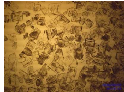
Şekil EK-1.1. MSMPR kristalizörde üretilen sodyum tetrafloroborat kristallerinin mikroskop görüntüleri (sıcaklık:80-30°C, debi:52ml/dk., karıştırma hızı: 300 rpm, büyütme 32X)
