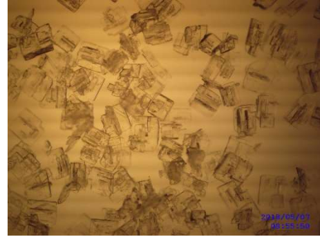
Şekil EK-1.3. MSMPR kristalizörde üretilen sodyum tetrafloroborat kristallerinin mikroskop görüntüleri (sıcaklık:80-30°C, debi:68ml/dk., karıştırma hızı: 300 rpm, büyütme 32X)
