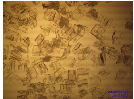
Şekil EK-1 1.26. MSMPR kristalizörde üretilen sodyum tetrafluoroborat kristallerinin mikroskop görüntüleri (sıcaklık: 80-30°C, debi: 52ml/dk., karıştırma hızı: 300 rpm, büyütme 32X, 1000 ppm borik asit katkılı)
