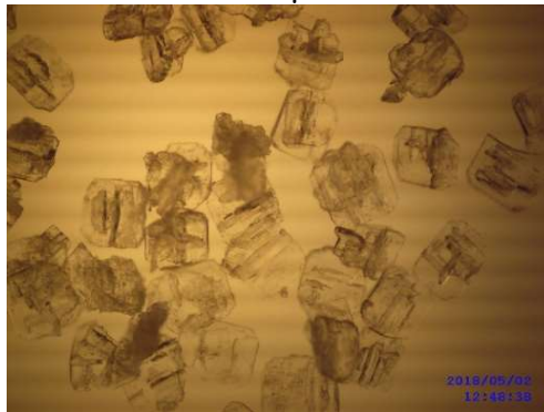
Şekil EK-1 1.23. MSMPR kristalizörde üretilen sodyum tetrafloroborat kristallerinin mikroskop görüntüleri (sıcaklık:80-30°C, debi:52ml/dk., karıştırma hızı: 300 rpm, büyütme 32X, 1000 ppm Magnezyum klorür)
