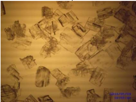
Şekil EK-1.4. MSMPR kristalizörde üretilen sodyum tetrafloroborat kristallerinin mikroskop görüntüleri (sıcaklık:80-30 °C, debi:52ml/dk., karıştırma hızı: 150 rpm, büyütme 32X)
