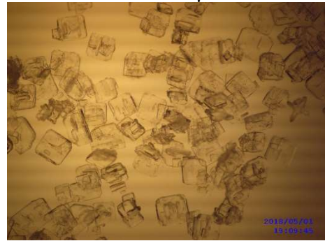
Şekil EK-1.6. MSMPR kristalizörde üretilen sodyum tetrafloroborat kristallerinin mikroskop görüntüleri (sıcaklık:80-30°C, debi:52ml/dk., karıştırma hızı: 400 rpm, büyütme 32X)
