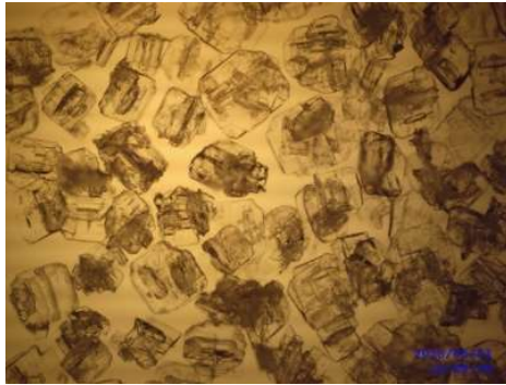
Şekil EK-1.1. MSMPR kristalizörde üretilen sodyum tetrafloroborat kristallerinin mikroskop görüntüleri (sıcaklık:80-30°C, debi:52ml/dk., karıştırma hızı: 300 rpm, büyütme 32X)
