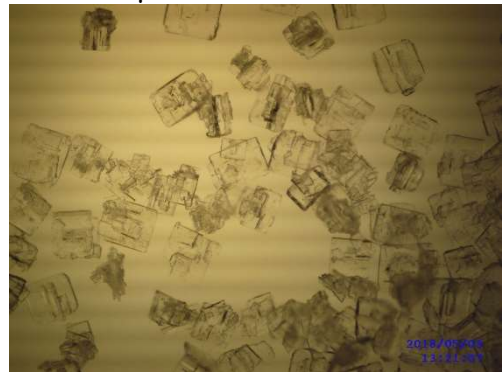
Şekil EK-1 1.25. MSMPR kristalizörde üretilen sodyum tetrafloroborat kristallerinin mikroskop görüntüleri, üretim şartları (sıcaklık:80-30°C, debi:52ml/dk., karıştırma hızı: 300 rpm, büyütme 32X, 500 ppm borik asit katkılı).
