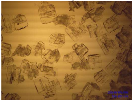
Şekil EK-1.2. MSMPR kristalizörde üretilen sodyum tetrafloroborat kristallerinin mikroskop görüntüleri (sıcaklık:80-30°C, debi:58ml/dk., karıştırma hızı: 300 rpm, büyütme 32X)
