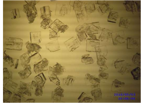
Şekil EK-1.15. MSMPR kristalizörde üretilen sodyum tetrafloroborat kristallerinin mikroskop görüntüleri (sıcaklık:80-30°C, debi:52ml/dk., karıştırma hızı: 300 rpm, büyütme 32X, % 0,5 Na 2 CO 3 katkılı)
