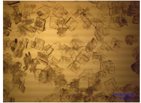
Şekil EK-1.17. MSMPR kristalizörde üretilen sodyum tetrafloroborat kristallerinin mikroskop görüntüleri, üretim şartları (sıcaklık:80-30°C, debi:52ml/dk., karıştırma hızı: 300 rpm, büyütme 32X, % 2 Na 2 CO 3 katkılı)
