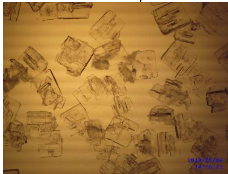
Şekil EK-1.5. MSMPR kristalizörde üretilen sodyum tetrafloroborat kristallerinin mikroskop görüntüleri (sıcaklık:80-30°C, debi:52ml/dk., karıştırma hızı: 200 rpm, büyütme 32X)
