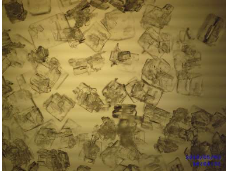
Şekil EK-1.15. MSMPR kristalizörde üretilen sodyum tetrafloroborat kristallerinin mikroskop görüntüleri (sıcaklık:80-30°C, debi:52ml/dk., karıştırma hızı: 300 rpm, büyütme 32X, % 0,5 Na 2 CO 3 katkılı)
