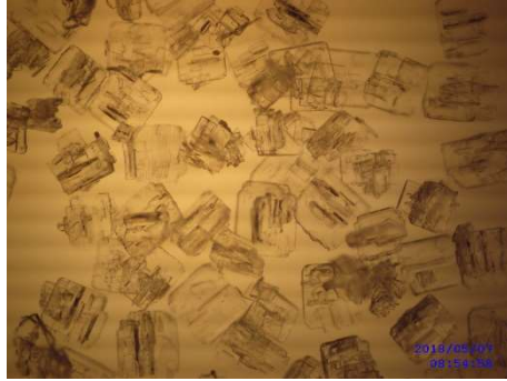
Şekil EK-1.3. MSMPR kristalizörde üretilen sodyum tetrafloroborat kristallerinin mikroskop görüntüleri (sıcaklık:80-30°C, debi:68ml/dk., karıştırma hızı: 300 rpm, büyütme 32X)
