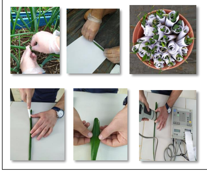
Şekil 3.14. Yaprak renk yoğunluğunu belirlemek için örnek alımı ve L a b değerlerinin ölçümü
