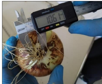
Şekil 3.24. Kök disk çapının dijital kumpas ile ölçümü
