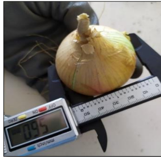
Şekil 3.19. Soğan çapının dijital kumpas ile ölçümü
