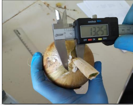
Şekil 3.25. Soğan genotiplerinde boyun genişliğinin dijital kumpas ile ölçümü
