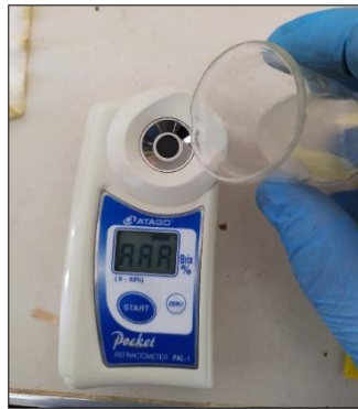
Şekil 3.21. Soğan genotiplerinde SÇKM içeriğinin dijital refraktometre ile ölçümü
