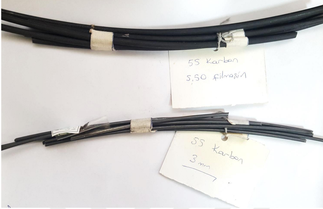
Şekil 3.1. Deneyisel çalışmalarda kullanılan C55 çelik tel numuneler.
