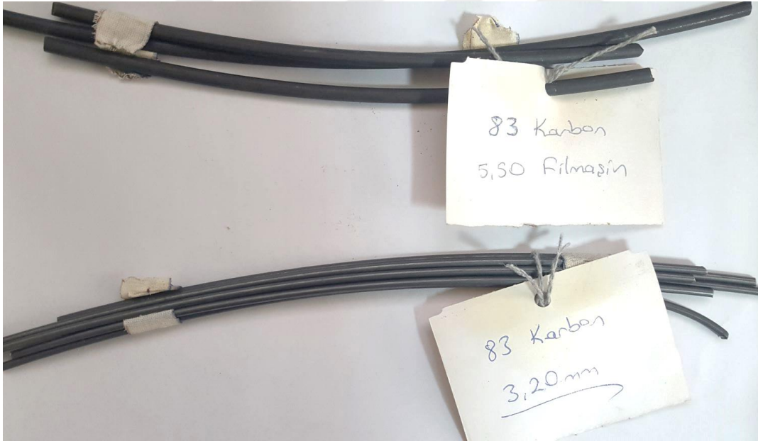
Şekil 3.1. Deneyisel çalışmalarda kullanılan C55 çelik tel numuneler.
