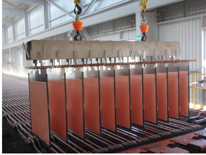
Şekil 2.16. Bakır elektro-rafinasyon tankı (Copper Alliance, 2022).
