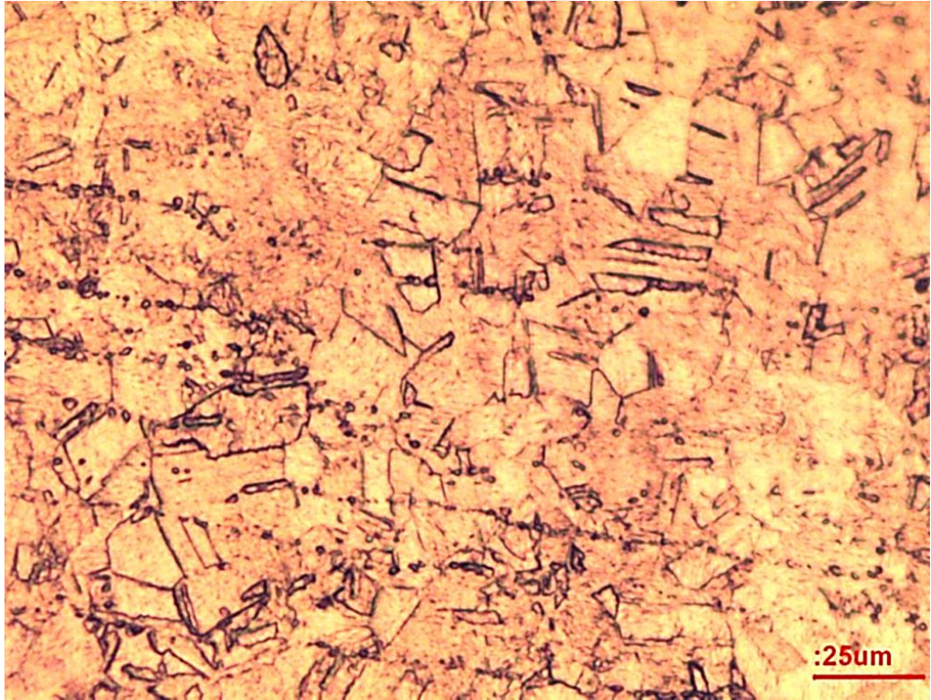
Şekil 4.1. Başlangıç bakır telin optik mikroskop görüntüsü (X20).
