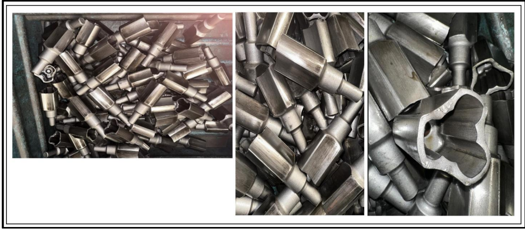
Şekil 4. 40. Otomotiv aks lalesinin soğuk dövme sonrası resimleri
