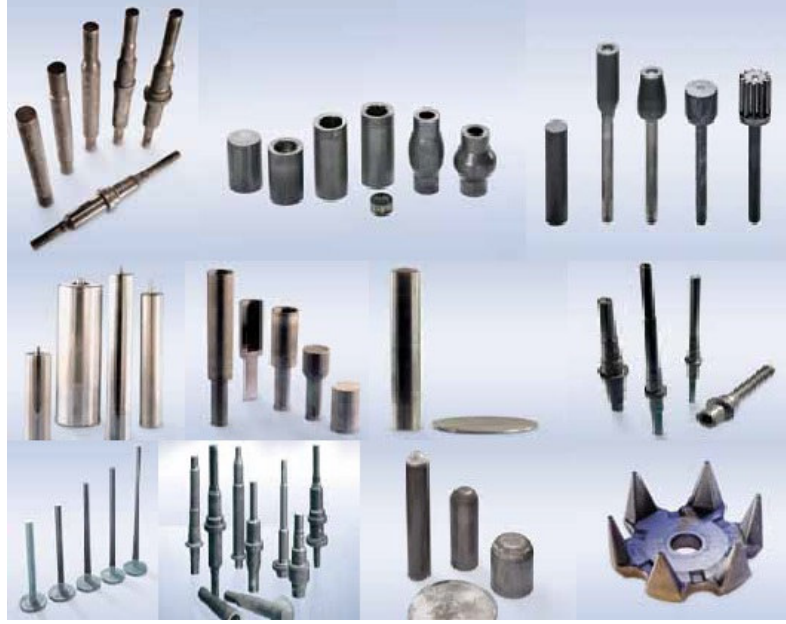
Şekil 2.22. Soğuk dövme işlemi ile üretilmiş bazı parçalar [27].
