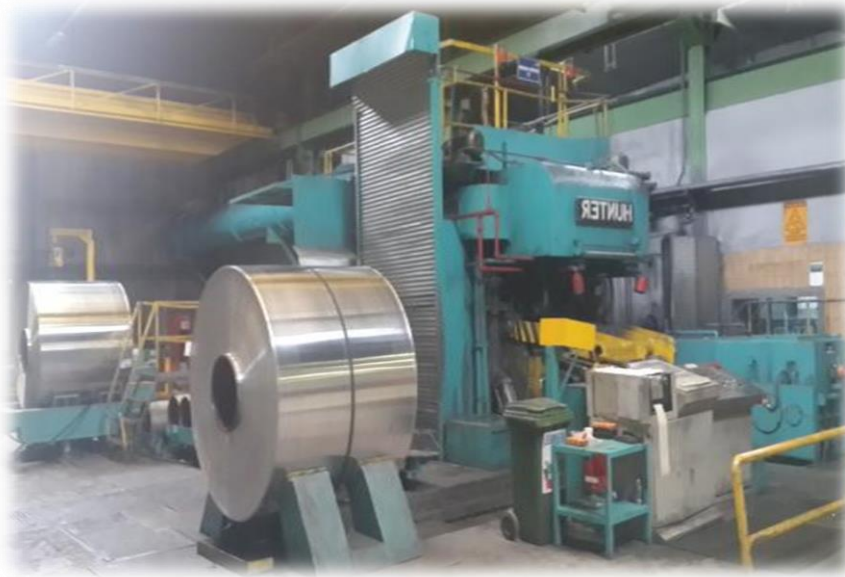
Şekil 4.4 : Soğuk hadde tezgahı (Assan Alüminyum A.Ş., Eğitim Notları, 1998).
