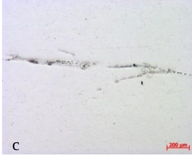
Şekil 6.2 : 50x büyütmede, 6 mm kalınlığında 3005 alaşım; a) Tavlanmamış, b) 580 °C, 8 saat tavlanmış, c) 550 °C, 8 saat tavlanmış, d) 520 °C, 8 saat tavlanmış.
