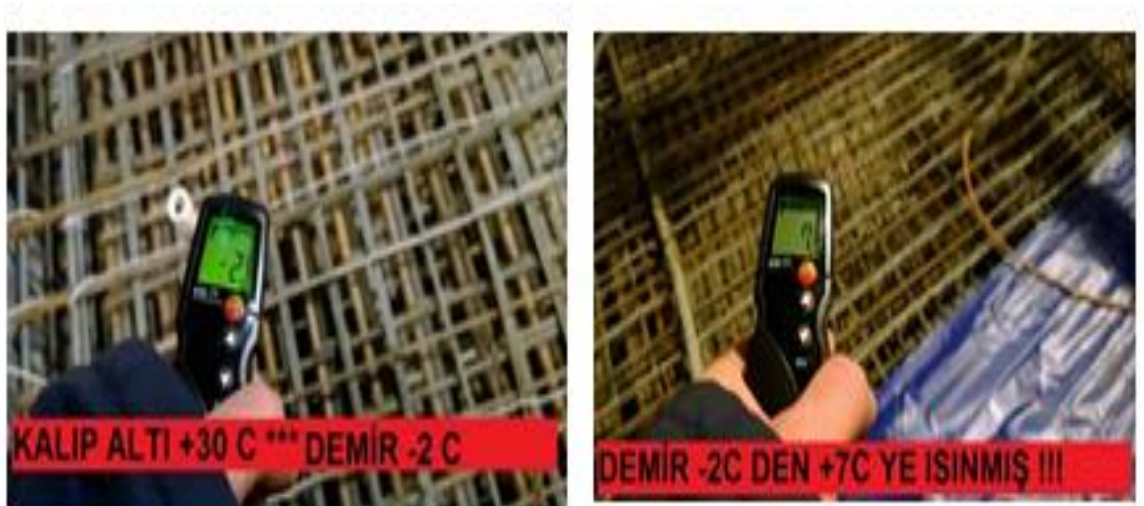
Şekil 4.7: Isı yalıtımlı branda testi.
