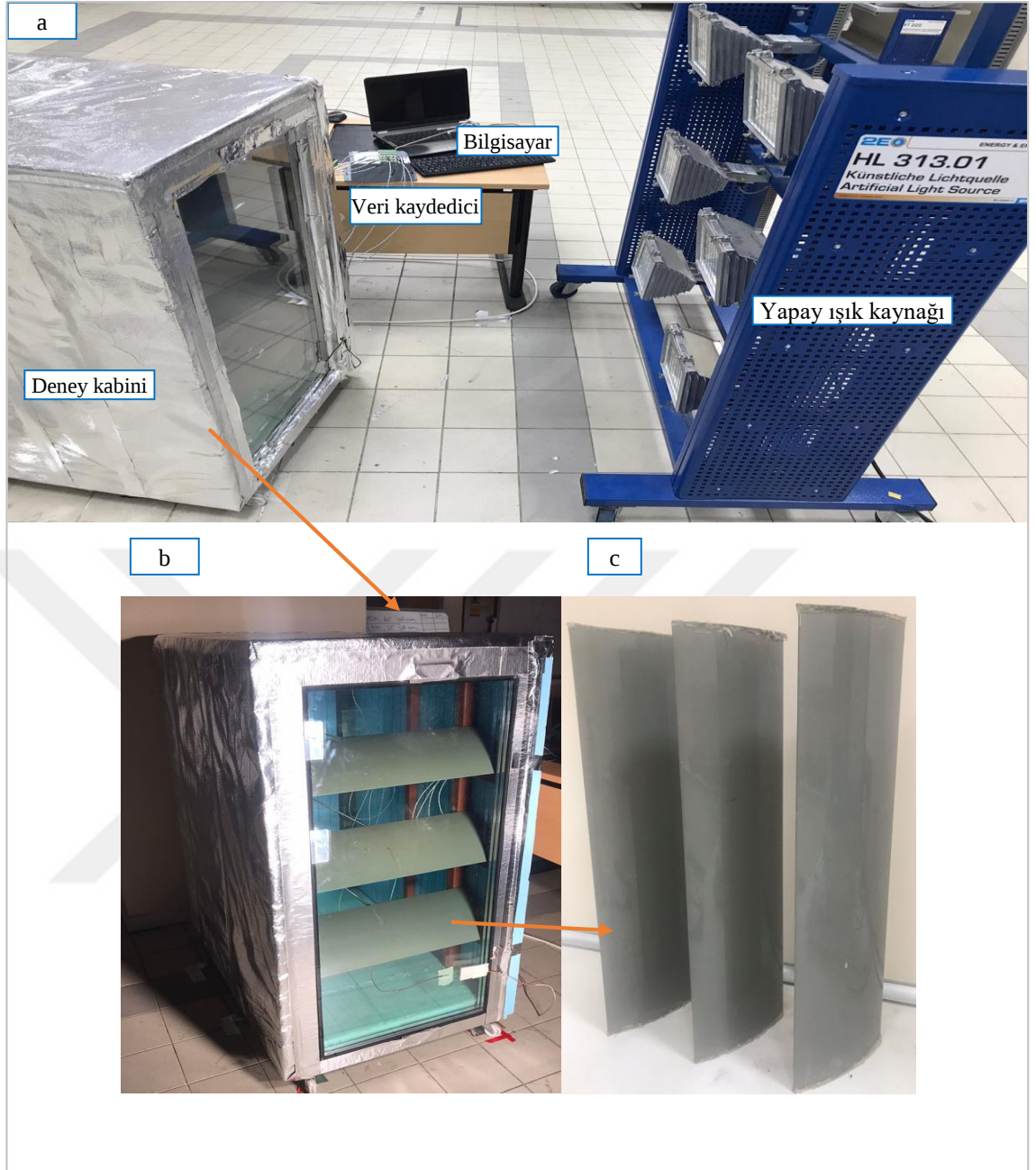
Şekil 3.1. a) Deney sistemi genel görüntüsü, b) Deney kabini fotoğrafı, c) GKE'lerinin fotoğrafı.
