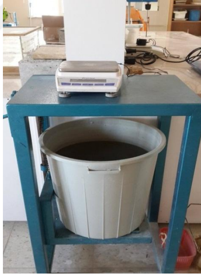
Resim 3.7 Arşimet prensibi ile çalışan tartı.
