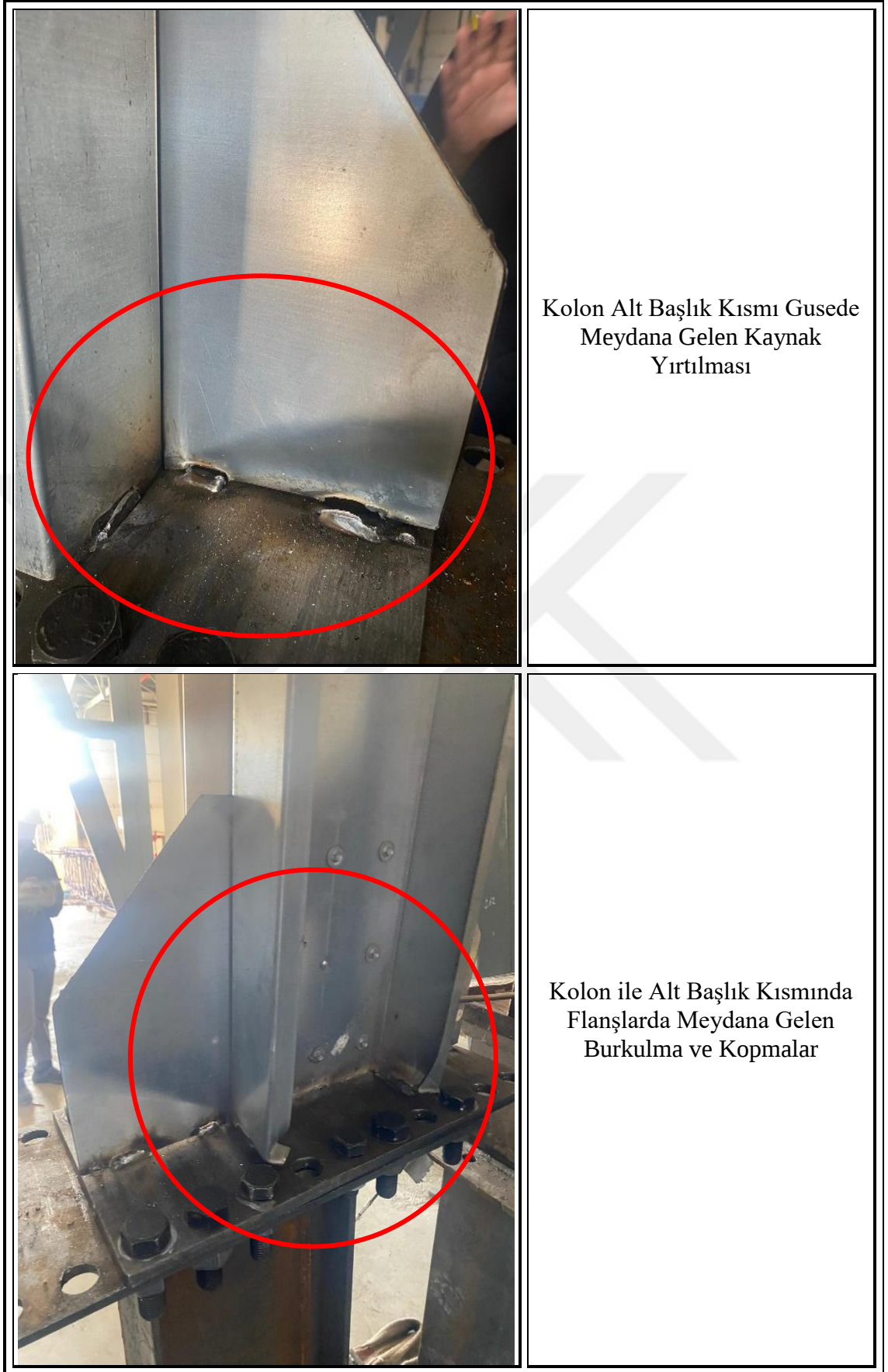
Şekil 4.8. Ex-2 deney sonrasında meydana gelen deformasyonlar
