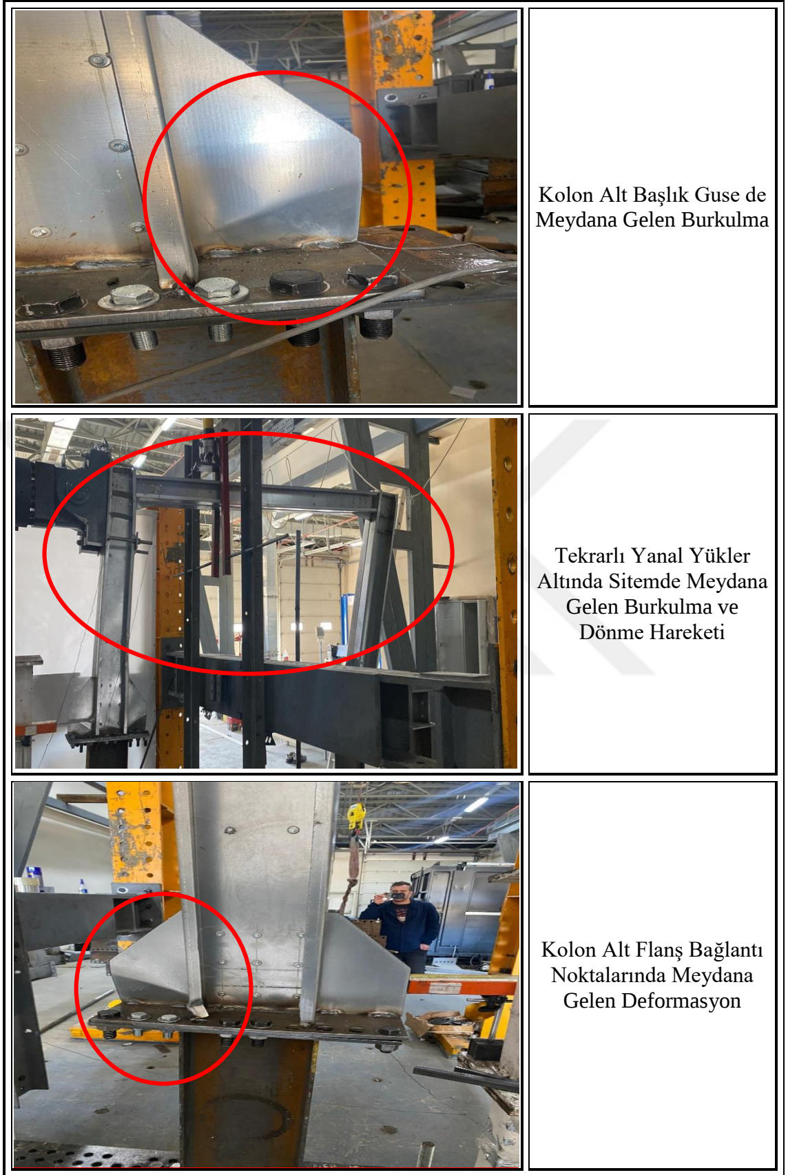
Şekil 4.11. Ex-5 deney sonrasında meydana gelen deformasyonlar
