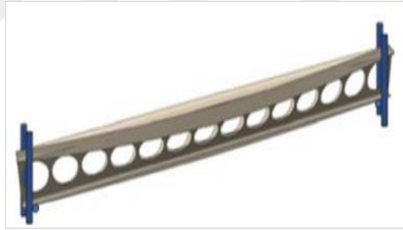
b. Dairesel kirişte yanıl burulmalı burkulma (Sonck 2015)
