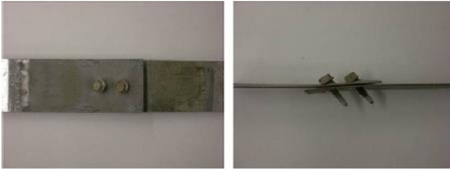
Şekil 2.7. Yüksek Sıcaklığa Maruz Kalmış Vida (Yan,2013)
