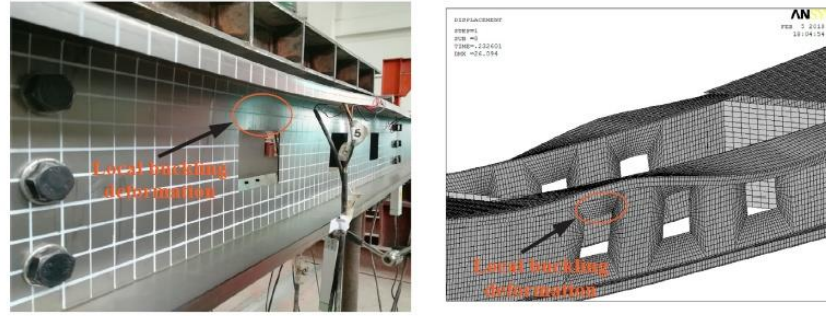
Şekil 2.3. Lokal Burkulma Deformasyonu (Zhao, 2019)
