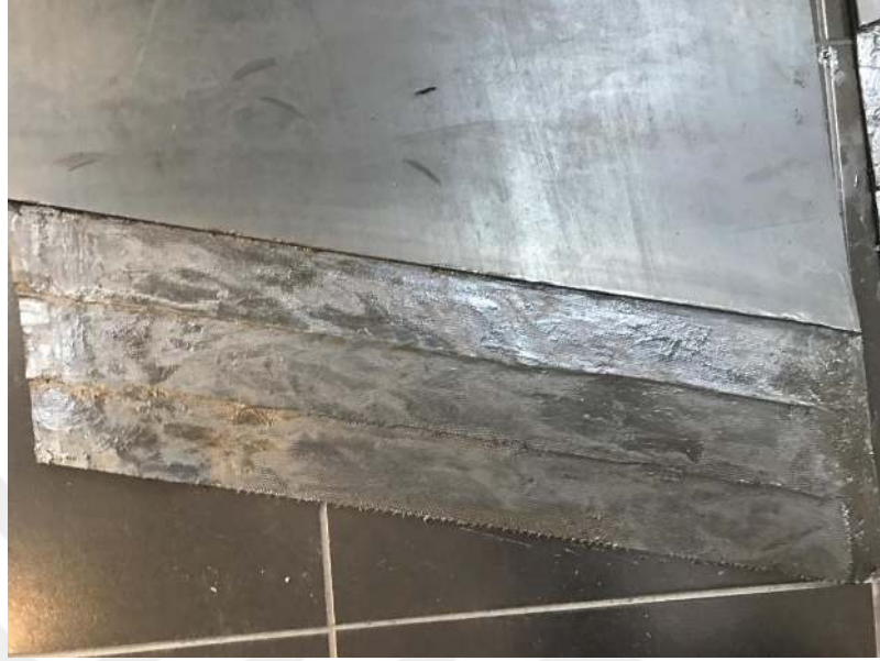
Şekil 7.26. İkinci kat soğuk vulkanize yapıştırıcı uygulanmış konveyör bant numuneleri.
