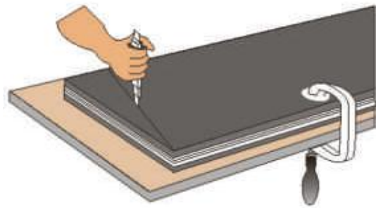
Şekil 4.5. Konveyör bantın çapraz kesim işlemi.
