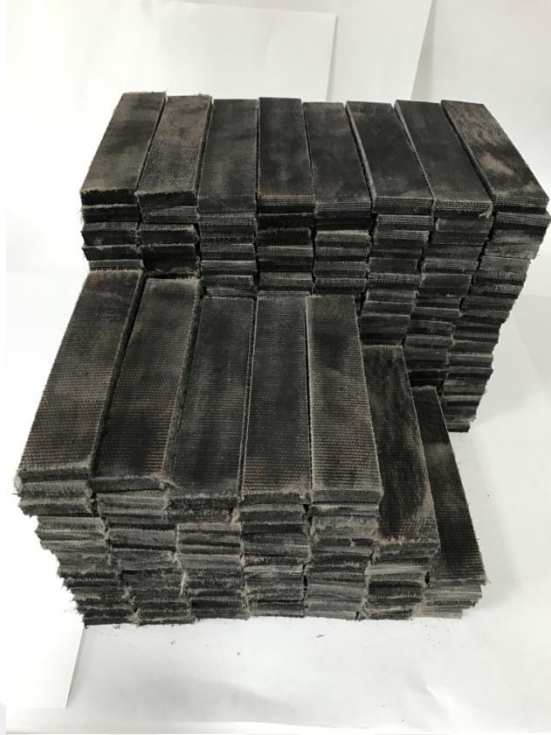
Şekil 7.7. Kesilen ve taşlanan konveyör bant numuneleri.
