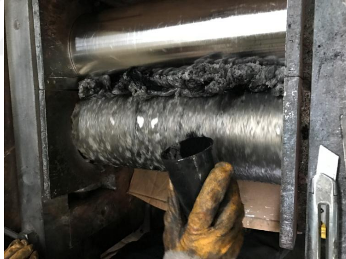
Şekil 7.4. Kloropren kauçuk hamuruna dolgu maddelerinin eklenmesi.
