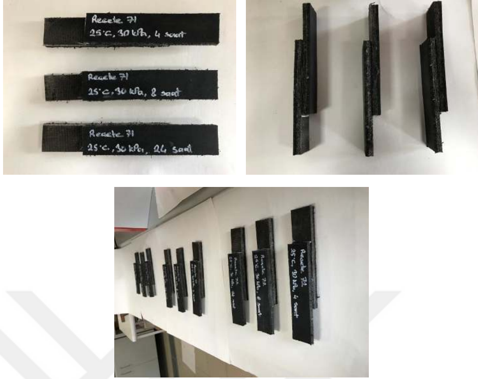
Şekil 7.11. Yapıştırılmış konveyör bant numuneleri.
