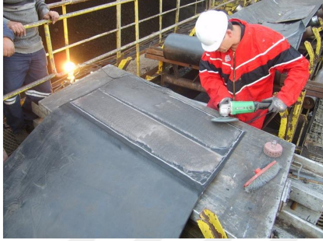
Şekil 2.6. Konveyör bantların soğuk vulkanizasyon ile eklenmesi (SC Top Rubber Service SRL, 2013).
