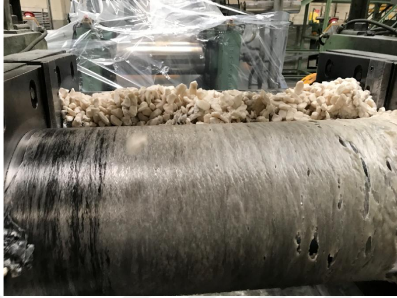
Şekil 7.19. Kloropren kauçuğun homojen hamur haline getirilmesi.
