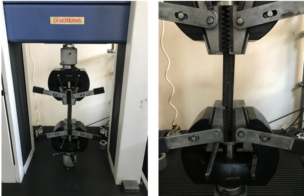
Şekil 7.15. Kayma gerilmesi testi uygulaması.
