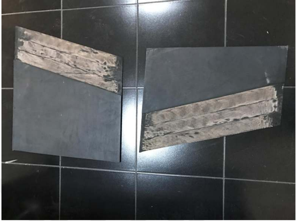
Şekil 7.24. Katları ayrılmış ve taşlanmış konveyör bant numuneleri.
