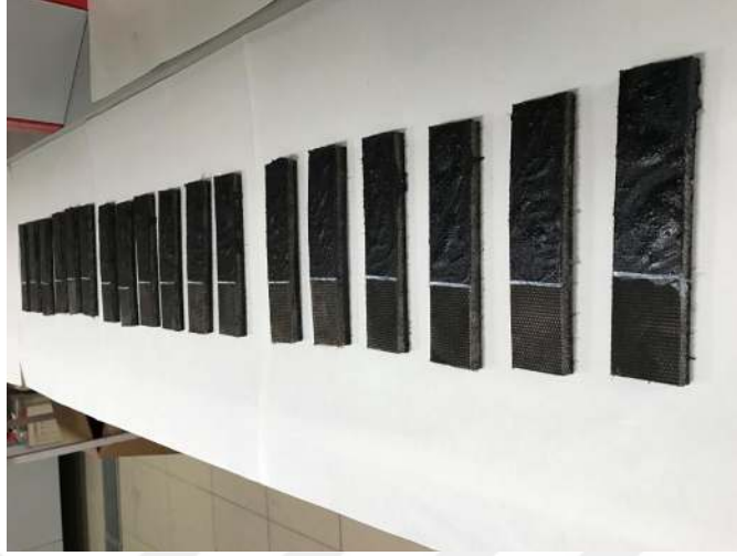
Şekil 7.9. Soğuk vulkanize yapıştırıcı uygulanmış konveyör bant numuneleri.
