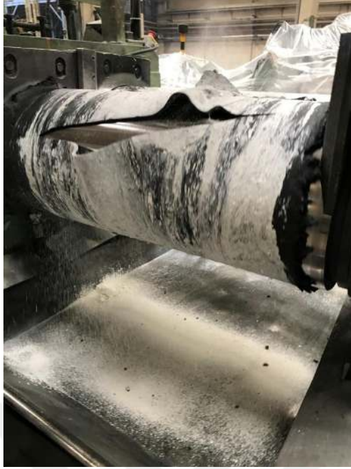
Şekil 7.21. Silika dolgu maddesinin kloropren kauçuk hamuru ile karışımı.
