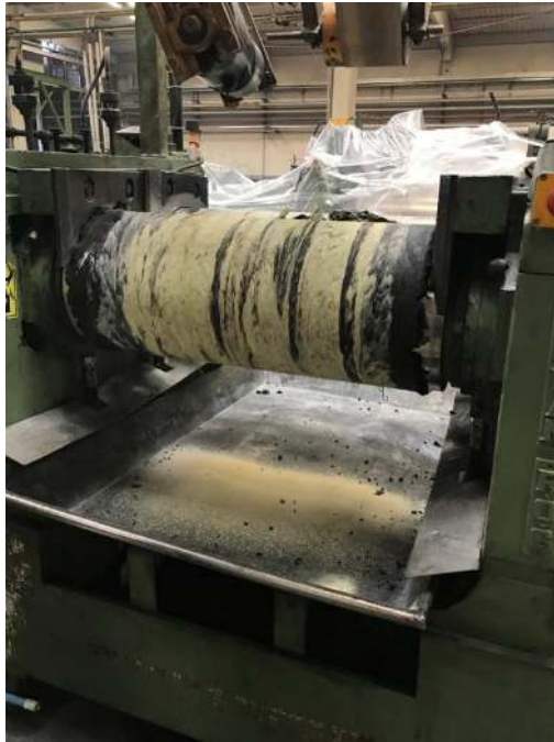
Şekil 7.22. Metal oksitlerin ve hızlandırıcıların kloropren kauçuk hamuru ile karışımı.
