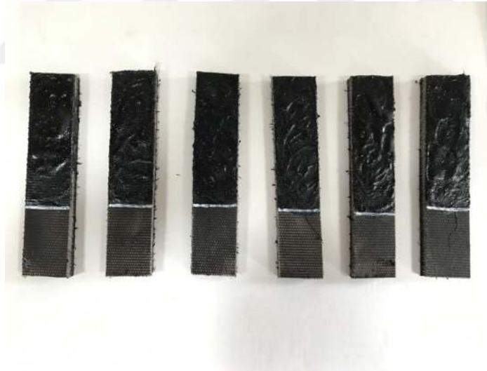
Şekil 7.10. Yapıştırma öncesi konveyör bant numuneleri.
