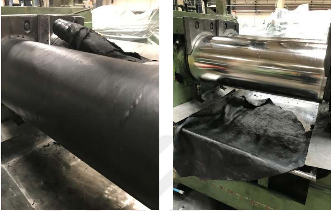
Şekil 7.23. Kloropren kauçuk hamurunun bant haline getirilmesi.
