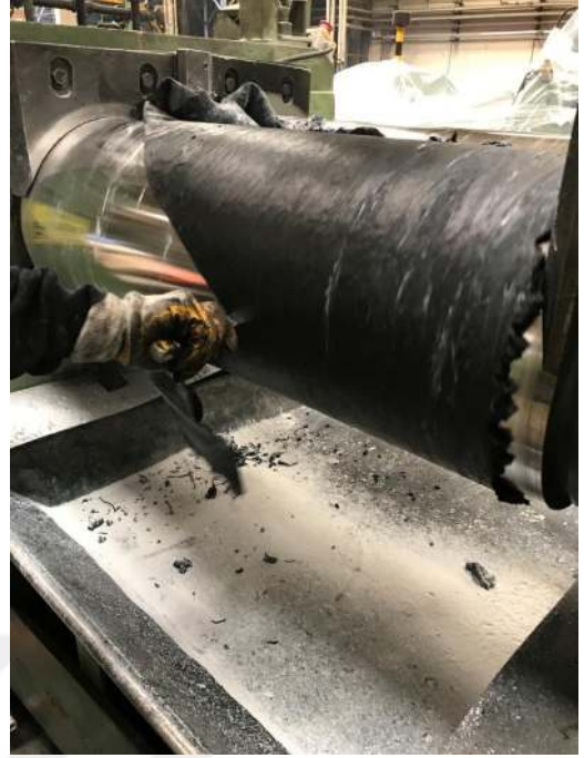
Şekil 7.21. Silika dolgu maddesinin kloropren kauçuk hamuru ile karışımı.
