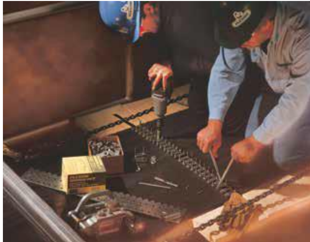
Şekil 2.7. Konveyör bantların mekanik ekler ile birleştirilmesi (Flexco, 2015).
