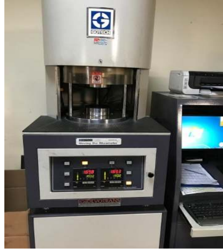
Şekil 7.14. 60 Tech M 2000 A MDR hareketli kalıp reometresi.
