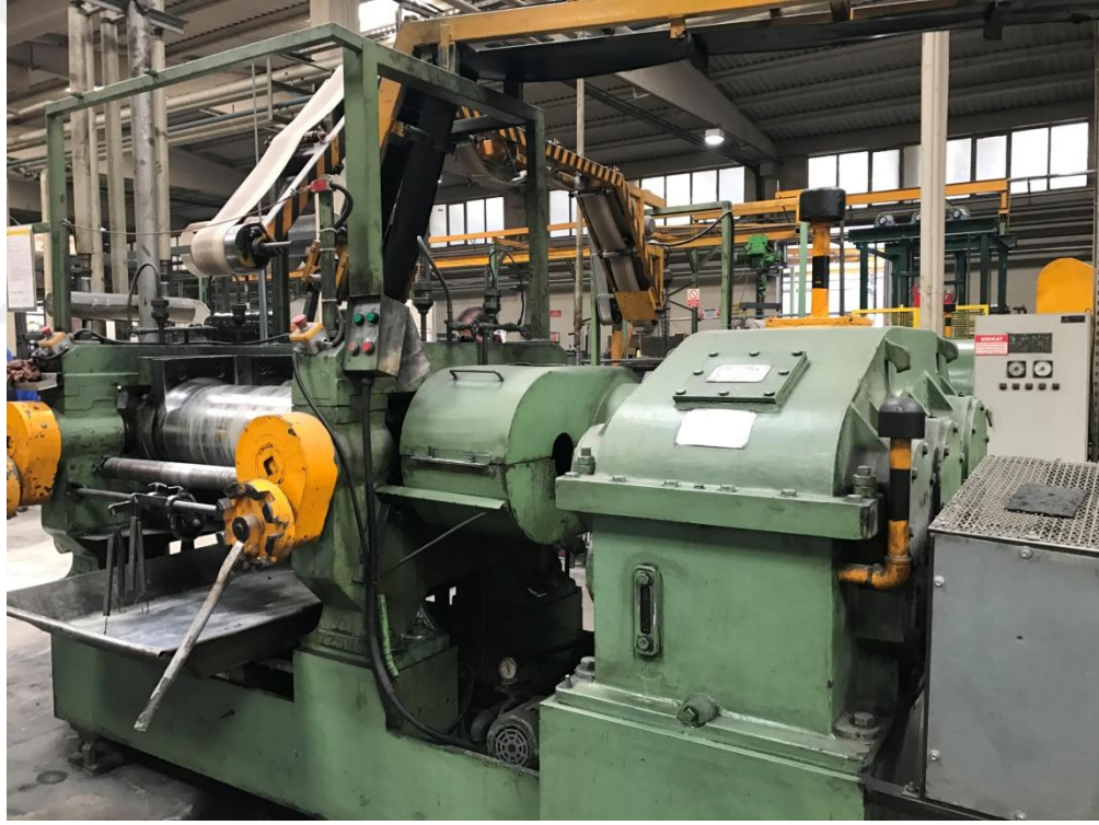
Şekil 7.18. İki silindirli açık karıştırma mili.
