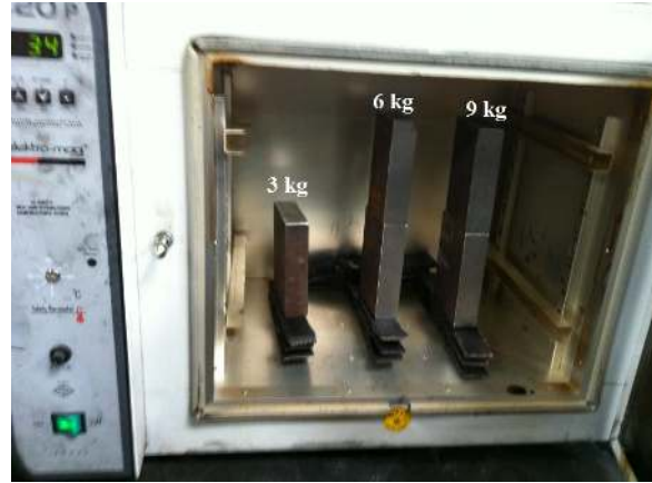
Şekil 7.13. Etüv içerisindeki konveyör bant numuneleri.
