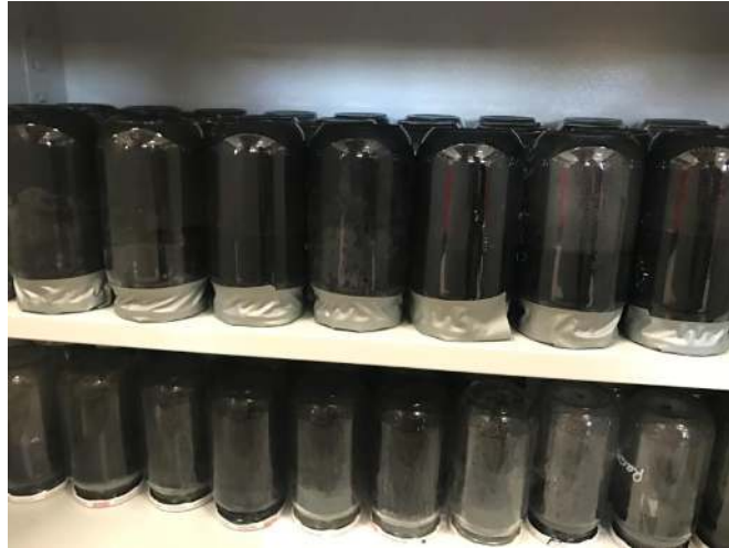
Şekil 7.6. Depolanan soğuk vulkanize yapıştırıcı sementleri.
