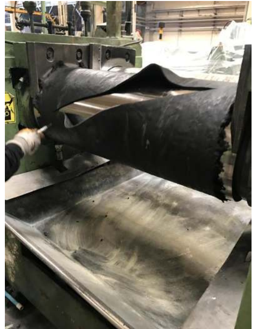
Şekil 7.22. Metal oksitlerin ve hızlandırıcıların kloropren kauçuk hamuru ile karışımı.
