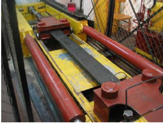
Şekil 6.1. Konveyör bant ek yeri analizi için çekme mukavemeti test cihazı.
