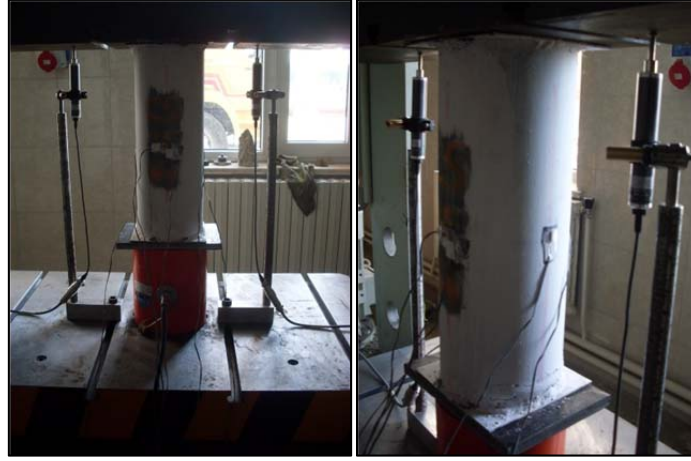
Şekil 4.8. CS1500 numunesi deney öncesi ve sonrası
