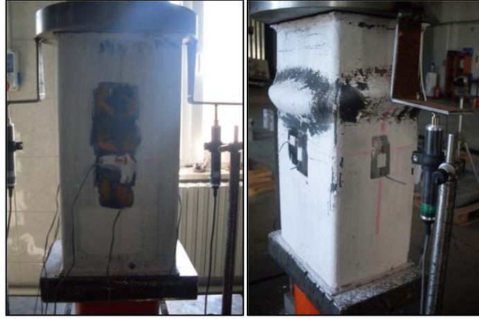
Şekil 4.131. RS5010 numunesi deney öncesi ve sonrası
