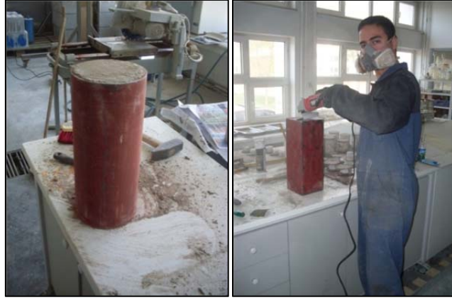
Şekil 3.12. Sürtünme kuvveti numunelerinin hazırlanması
