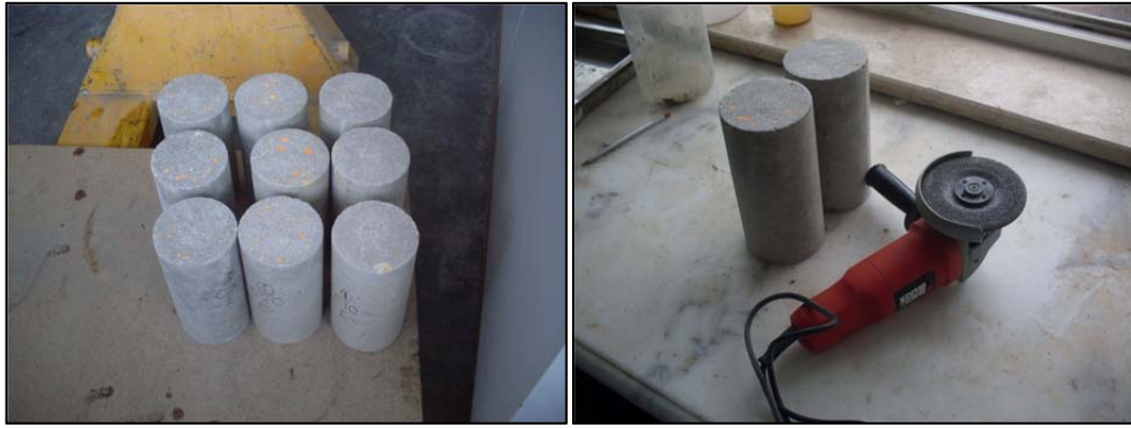
Şekil 3.3. Elastisite modülü beton numune başlıklarının düzlenmesi
