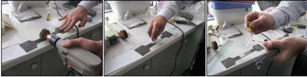
Şekil 3.11. Birim şekil değiştirme ölçer (strain gauge) yapıştırma aşamaları
