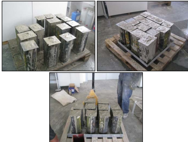
Şekil 3.24. Beton dökümü tamamlanan CFST numuneleri (sırasıyla C10, C20 ve C30 serileri)
