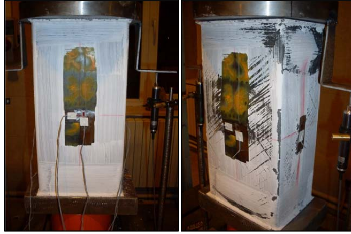
Şekil 4.125. RS3030 numunesi deney öncesi ve sonrası
