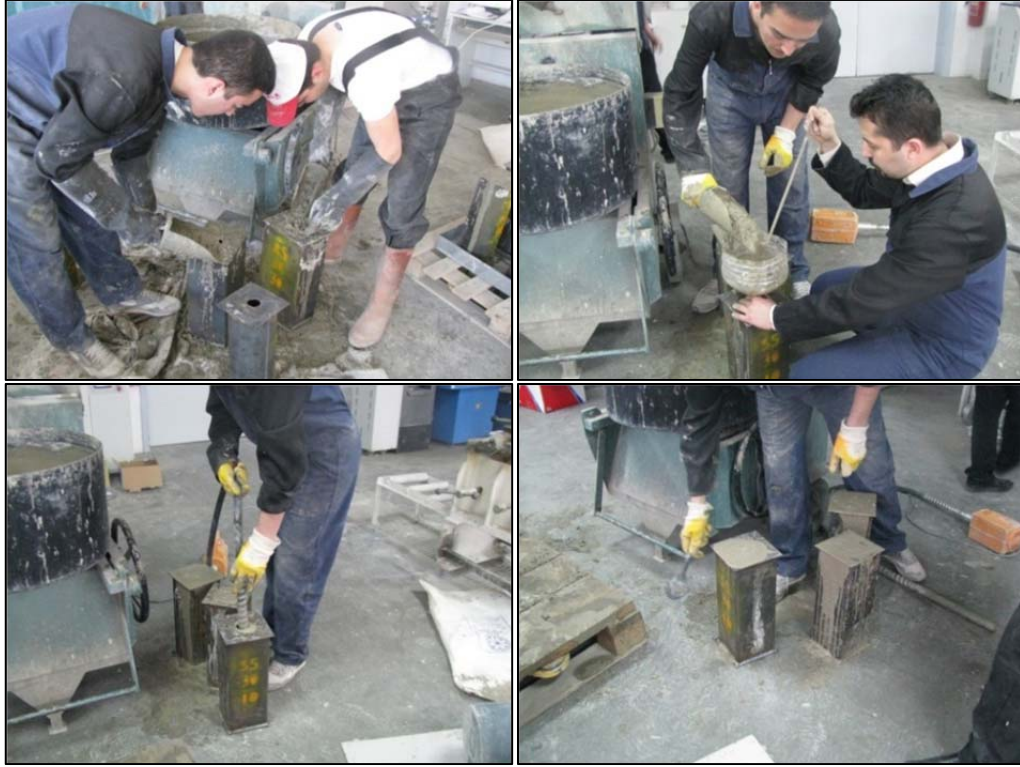
Şekil 3.23. Çelik numunelerinin içerisine beton dökümü
