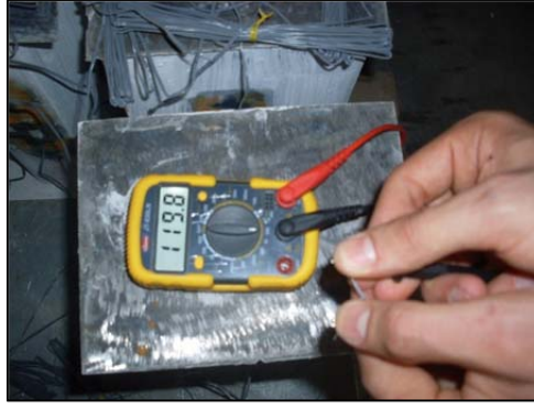
Şekil 3.34. Birim şekil değıştirme ölçer direnç değeri
