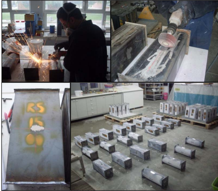
Şekil 3.27. Birim Deformasyon Ölçerlerin Konumlarının Belirlenmesi ve Kireçleme
