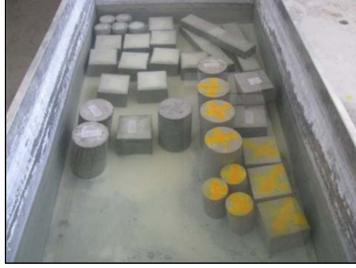
Şekil 3.9. Kür işlemine bırakılan C10 numuneleri
