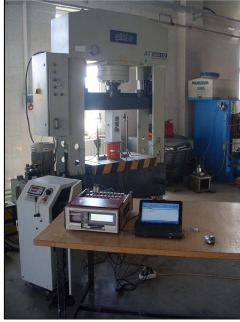
Şekil 3.33: CFST eksenel basınç deney düzeneği
