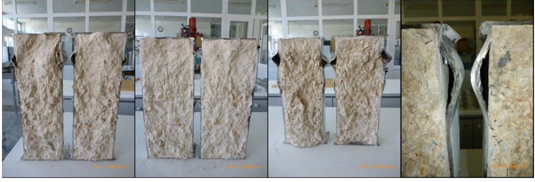
Şekil 6.12. 1.50 mm ve 3.00 mm cidar kalınlığına sahip daire, altıgen kesitler ile tüm dikdörtgen ve kare kesitlerde çelik tüpün betondan bağımsız gösterdiği burkulma davranışı
