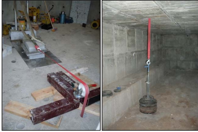
Şekil 3.14. Statik sürtünme katsayısı deney düzeneği
