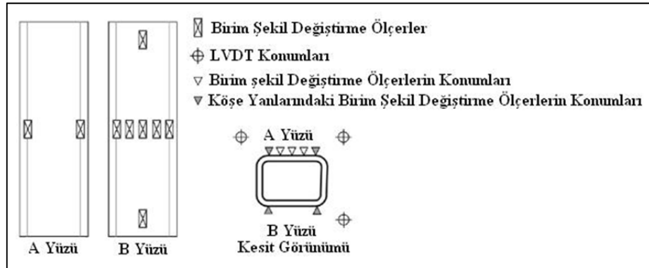
Şekil 2.8. Birim Şekil Değiştirme Ölçerler ve LVDT 'lerin numune üzerindeki konumları
