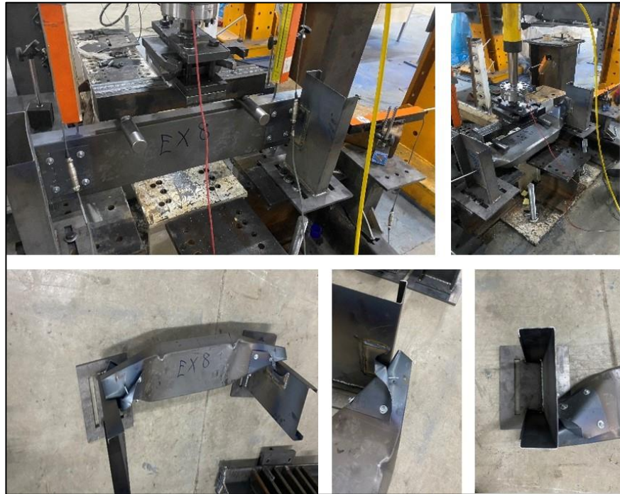
Şekil 4.6. EXP8-1,2-65-150 deney sonrası göçme görselleri
