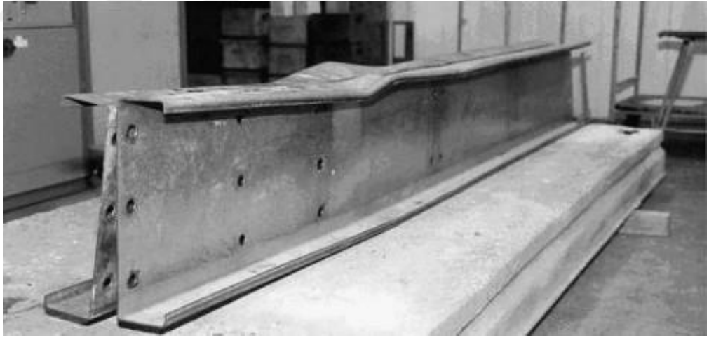
Şekil 2.6. Cıvatalı moment bağlantı elemanı bağlantı elemanı kiriş göçme durumu
