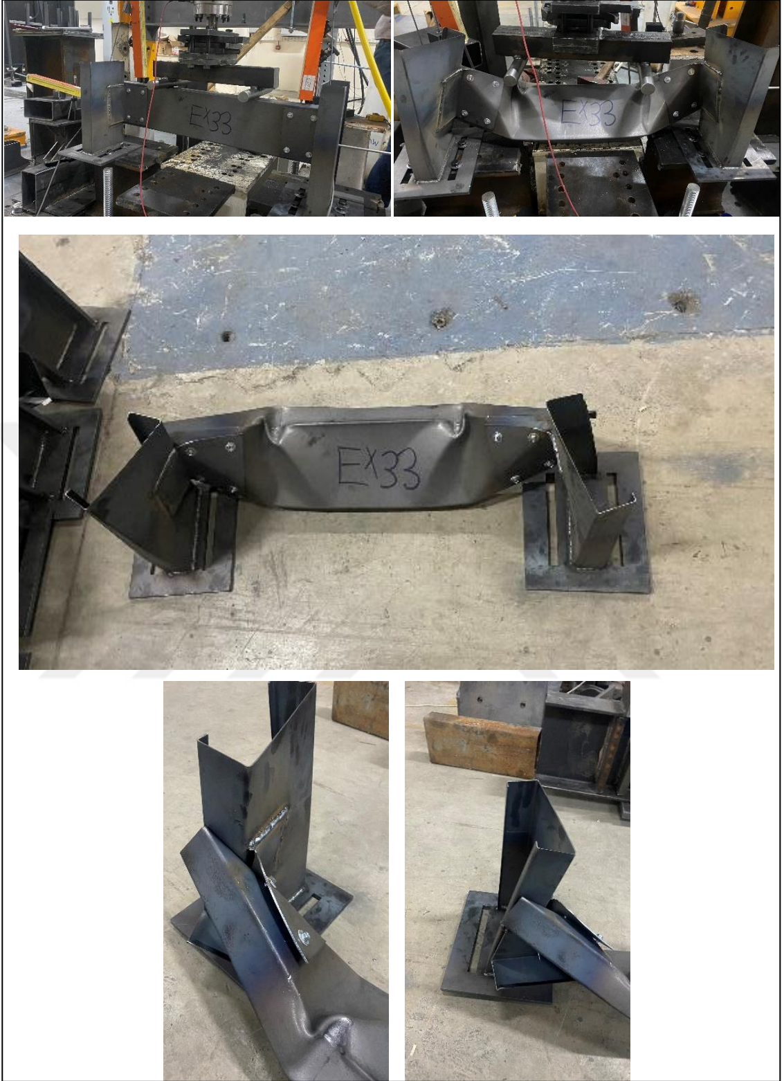
Şekil 4.47. EXP33-2,5-95-180 deney sonrası göçme görselleri
