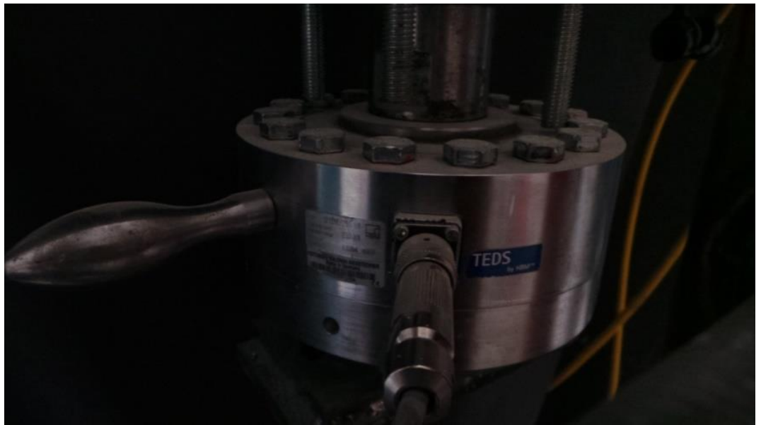
Şekil 3.13. Hidrolik yükleyici başlık
