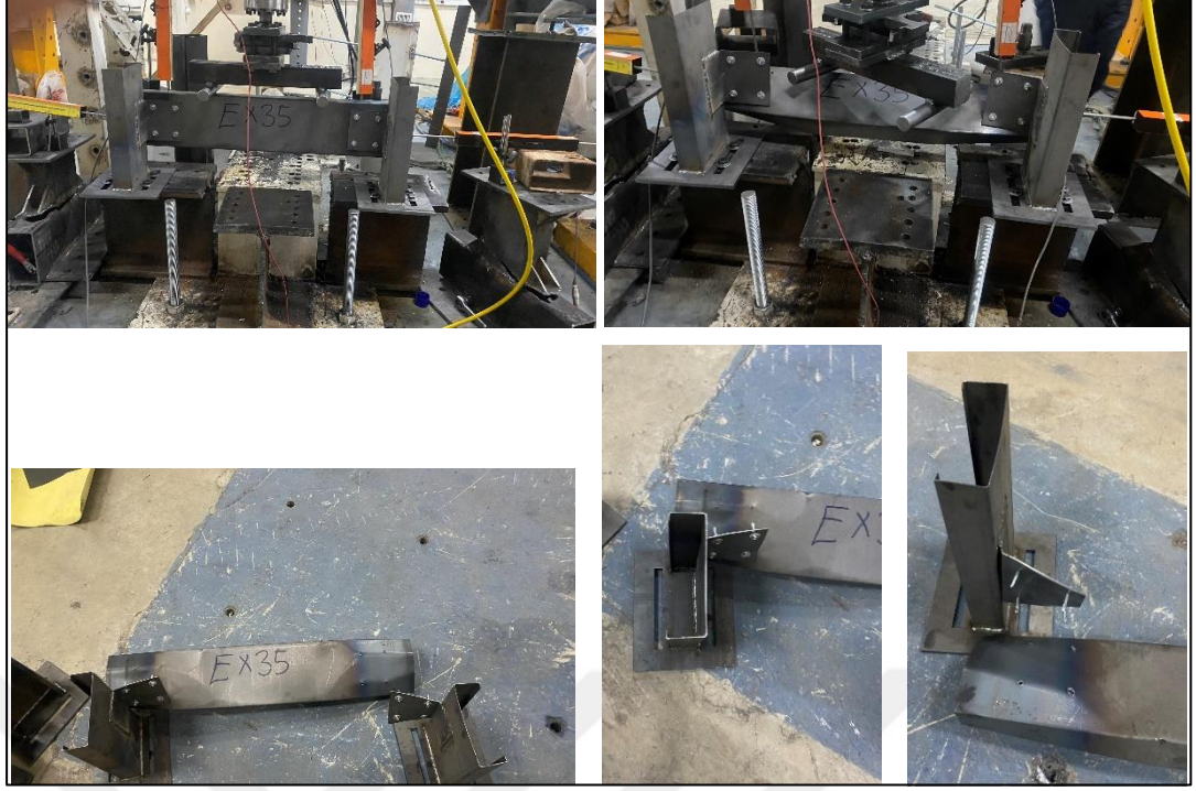
Şekil 4.43. EXP35-2,5-95-150 deney sonrası göçme görselleri
