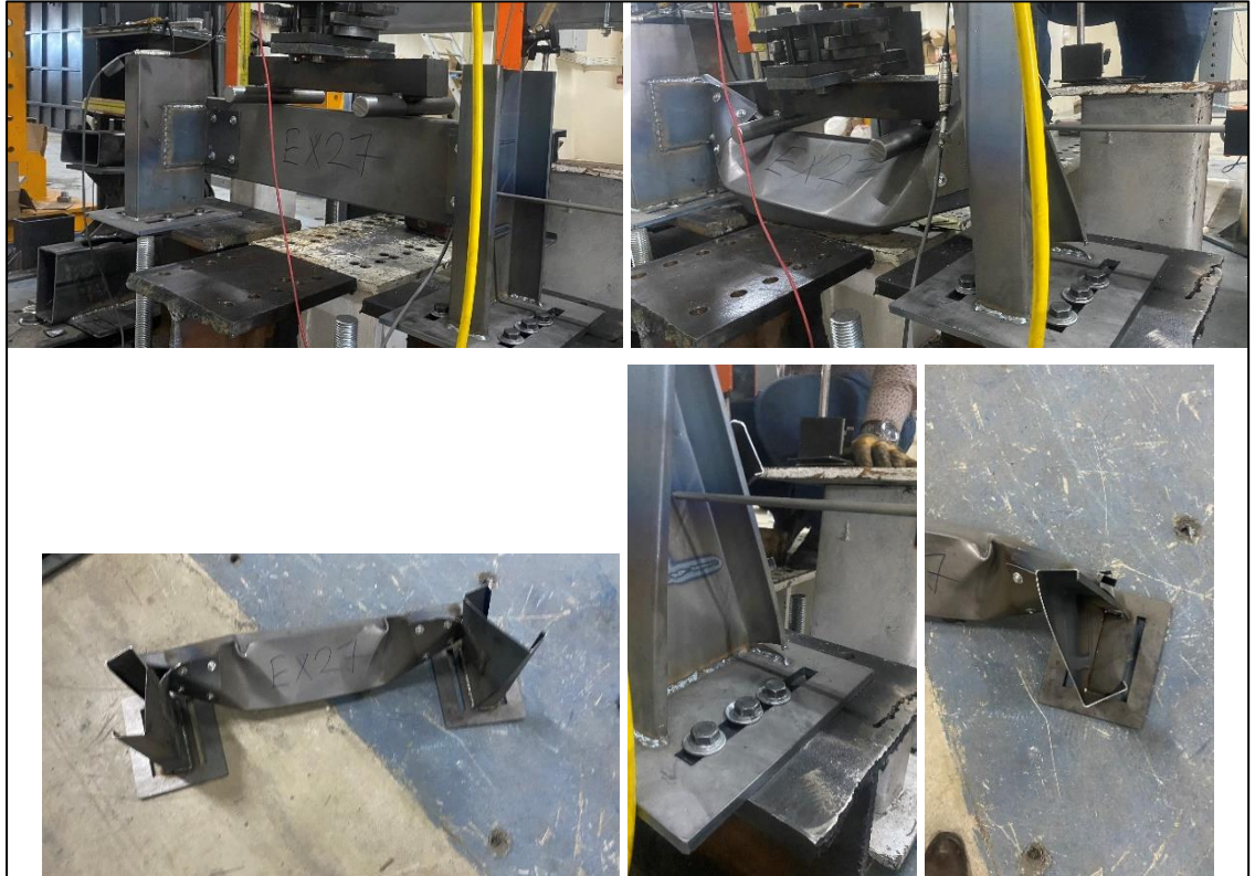
Şekil 4.44. EXP27-2,5-125-150 deney sonrası göçme görselleri
