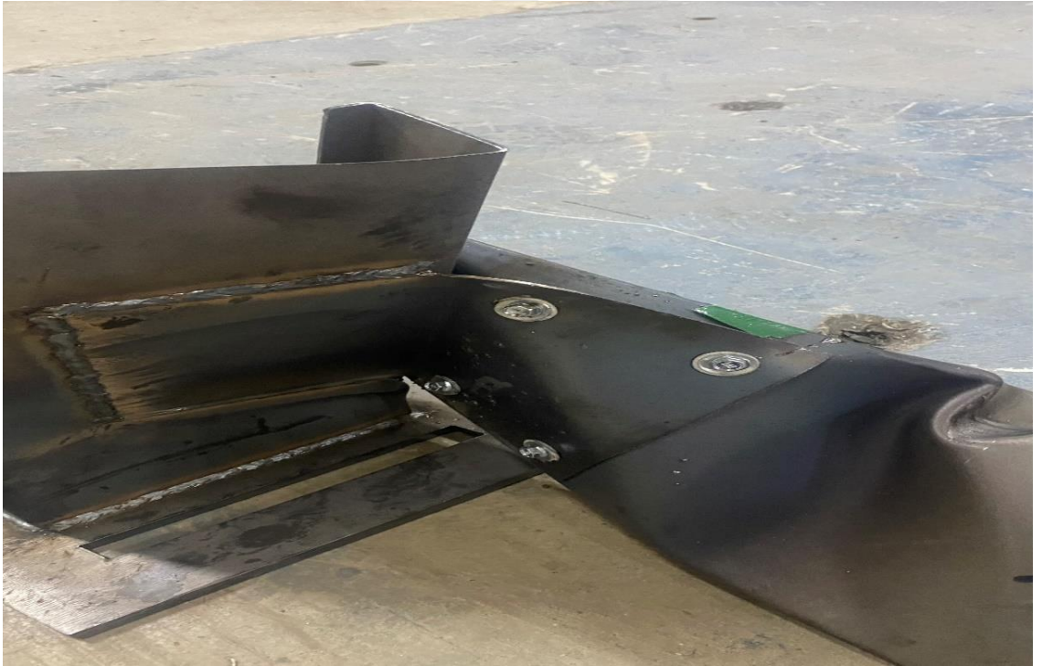
Şekil 4.77. 180 mm derinlikle bir plakalar kolon ve kiriş burkulması durumu
