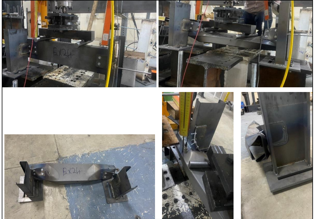
Şekil 4.39. EXP24-2,5-95-100 deney sonrası göçme görselleri
