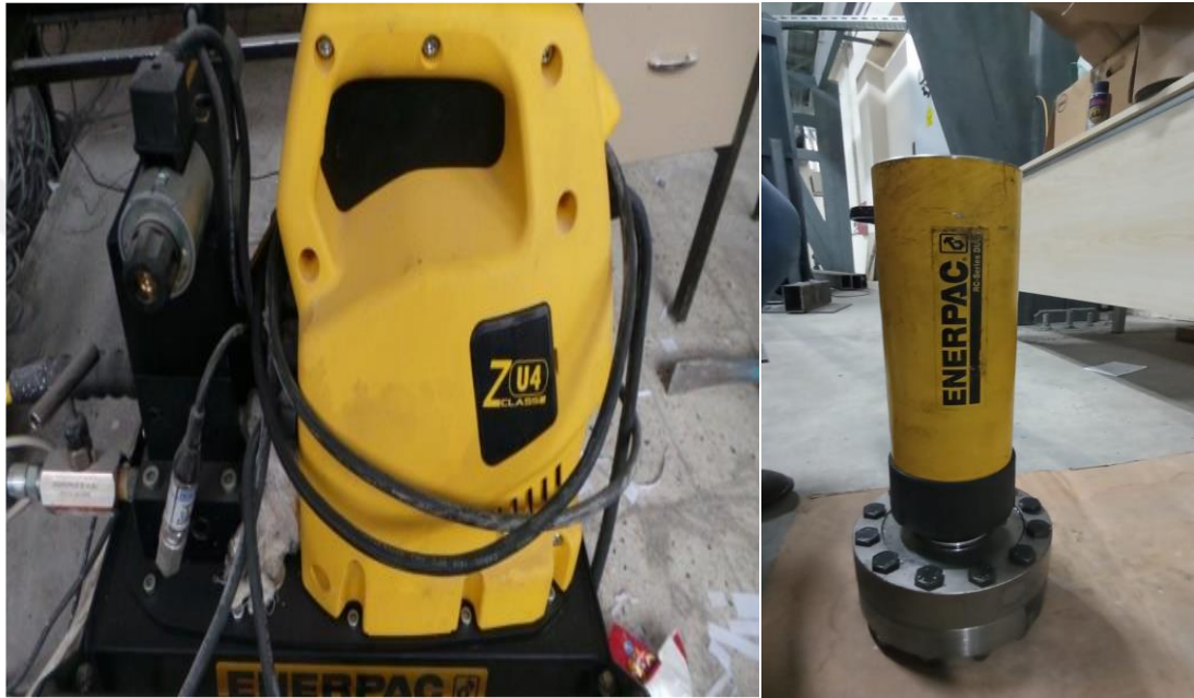
Şekil 3.14. Deneylerde kullanılan hidrolik piston ve pompa
