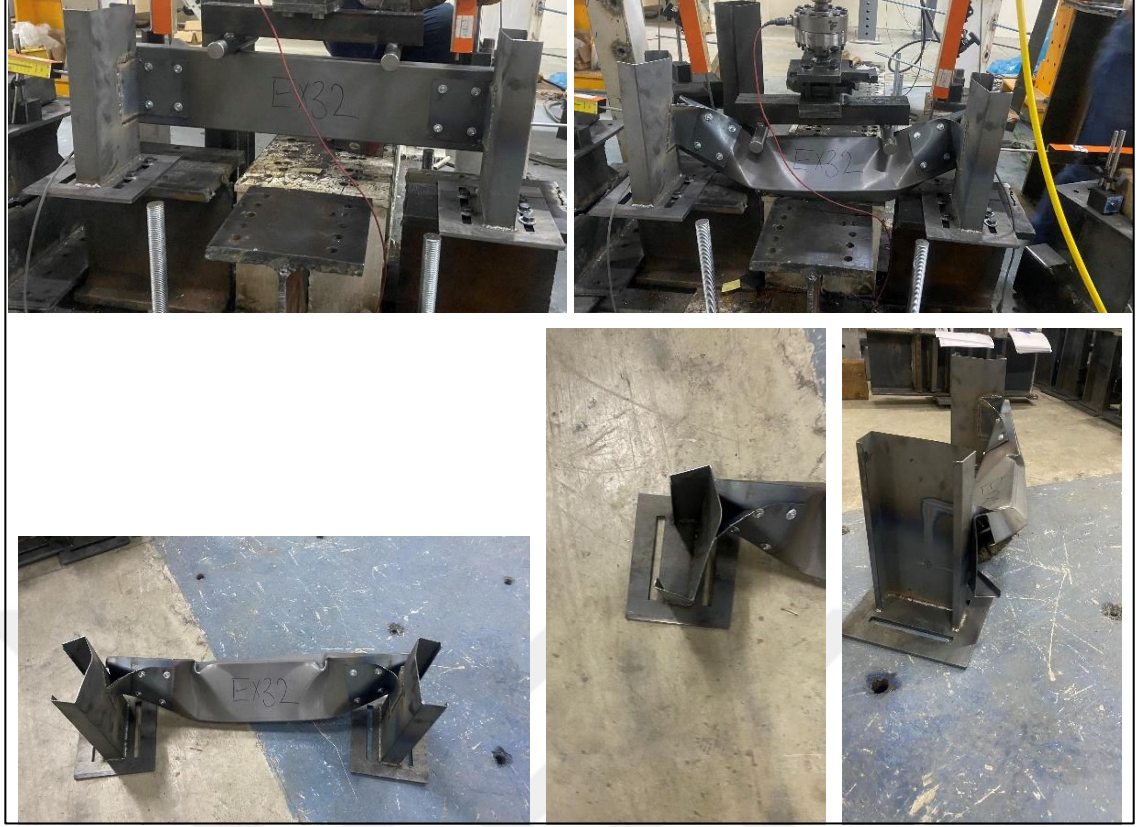
Şekil 4.31. EXP32-2-95-150 deney sonrası göçme görselleri
