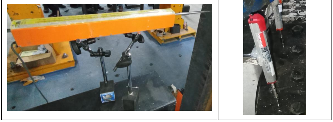
Şekil 3.15. Deneylerde kullanılan LVDT’ler
