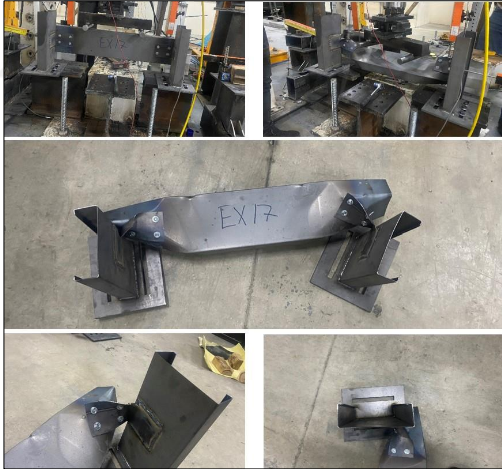
Şekil 4.16. EXP17-1,5-125-100 deney sonrası göçme görselleri
