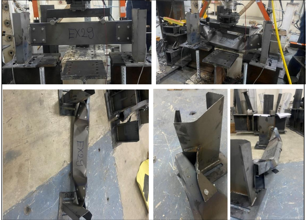
Şekil 4.30. EXP29-2-65-150 deney sonrası göçme görselleri
