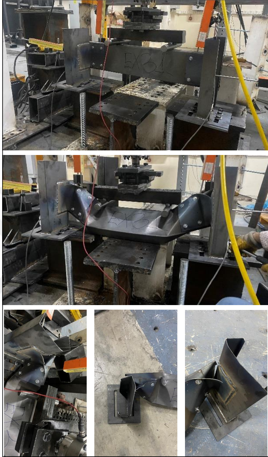
Şekil 4.36. EXP31-2-125-180 deney sonrası göçme görselleri
