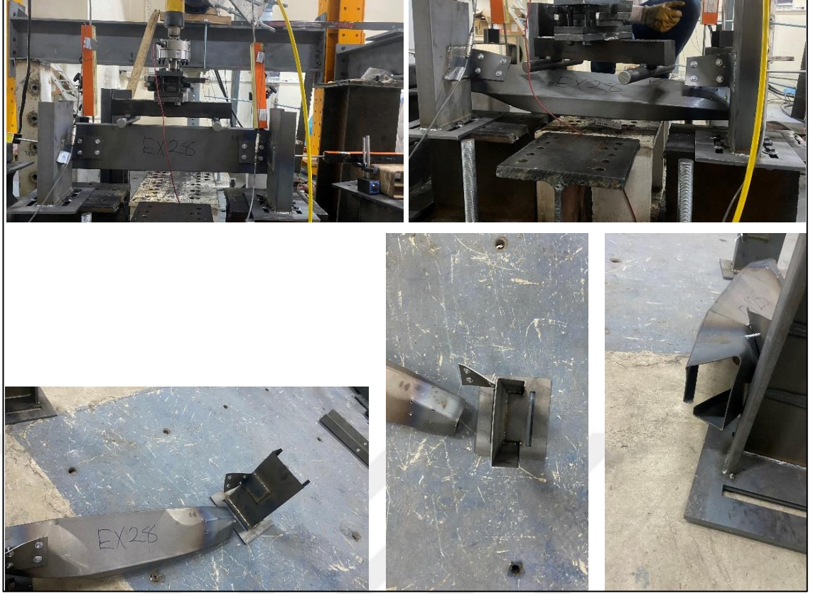
Şekil 4.40. EXP28-2,5-125-100 deney sonrası göçme görselleri
