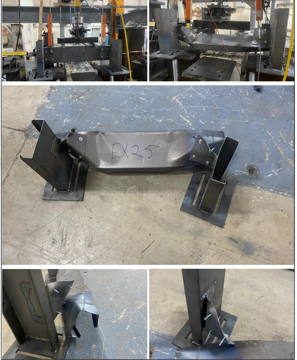
Şekil 4.19. EXP25-1,5-95-150 deney sonrası göçme görselleri
