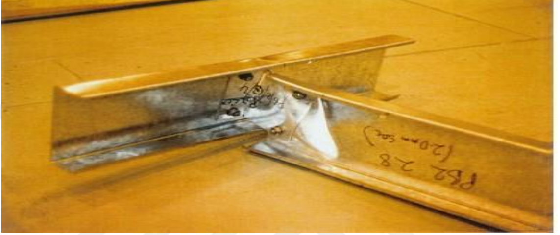
Şekil 2.2. Çelik gövde takozu göçme şekli
