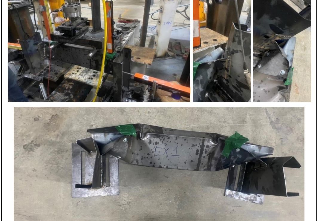
Şekil 4.22. EXP1-1,5-65-180 deney sonrası göçme görselleri
