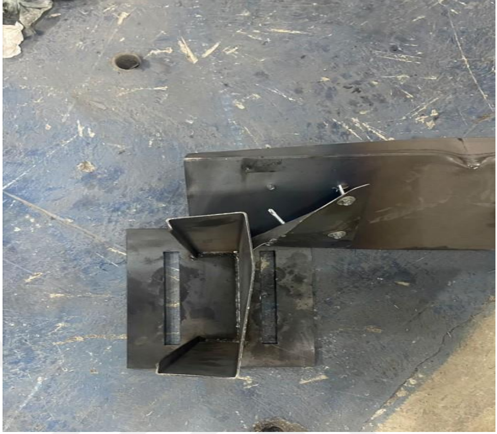
Şekil 4.68. Kolon distorsiyonel burkulması ve klips akıllı vida sıyırması örneği
