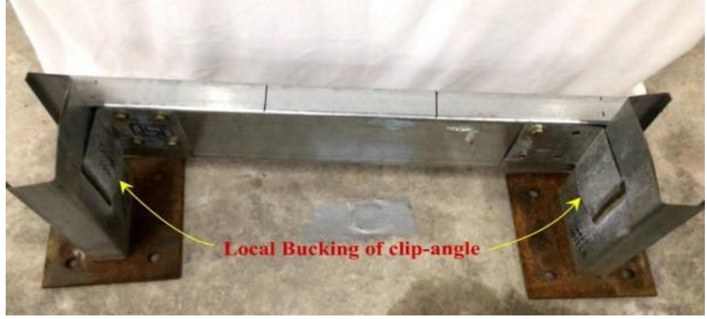
Şekil 2.15. Kanyaklı klips açıları lokal burkulması
