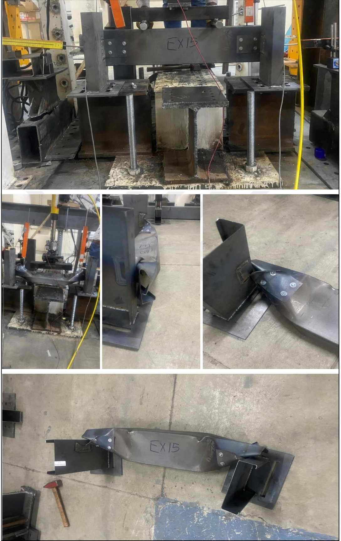
Şekil 4.14. EXP15-1,5-65-100 deney sonrası göçme görselleri
