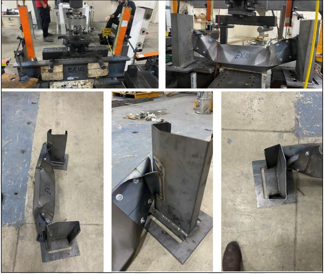
Şekil 4.10. EXP10-1,2-65-180 deney sonrası göçme görselleri
