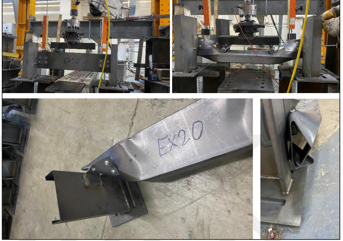
Şekil 4.38. EXP20-2,5-65-100 deney sonrası göçme görselleri
