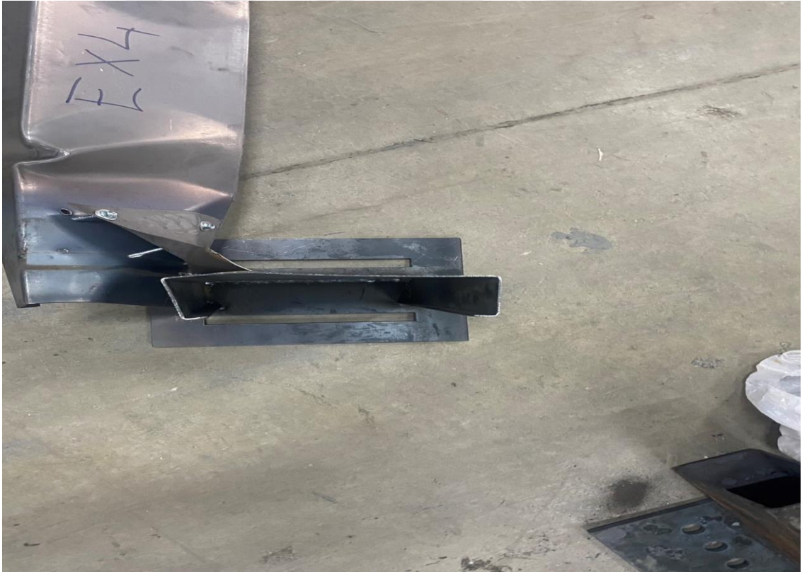
Şekil 4.73. Kolon distorsiyonal burkulması, klips açısı yırtılması ve vida sıyrması durumu.
