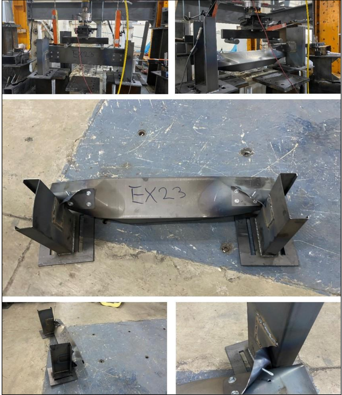
Şekil 4.4. EXP23-1,2-95-100 deney sonrası göçme görselleri
