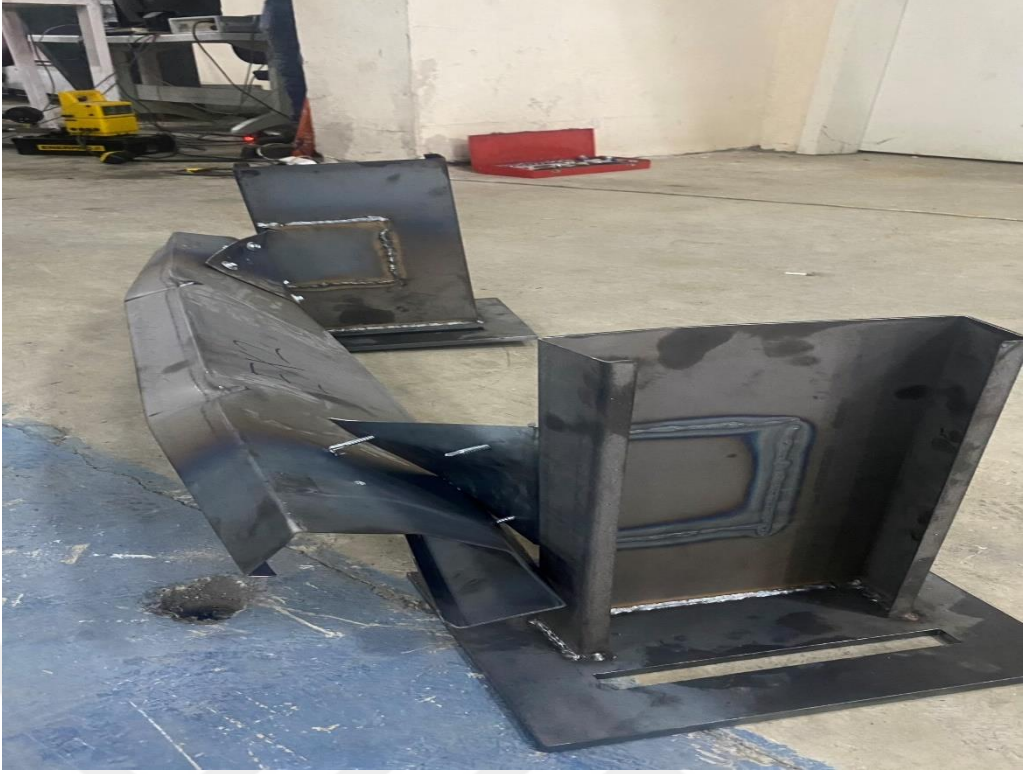
Şekil 4.70. Deneylerde kiriş burkulması ve klips açısı akıllı vida sıyırması durumu
