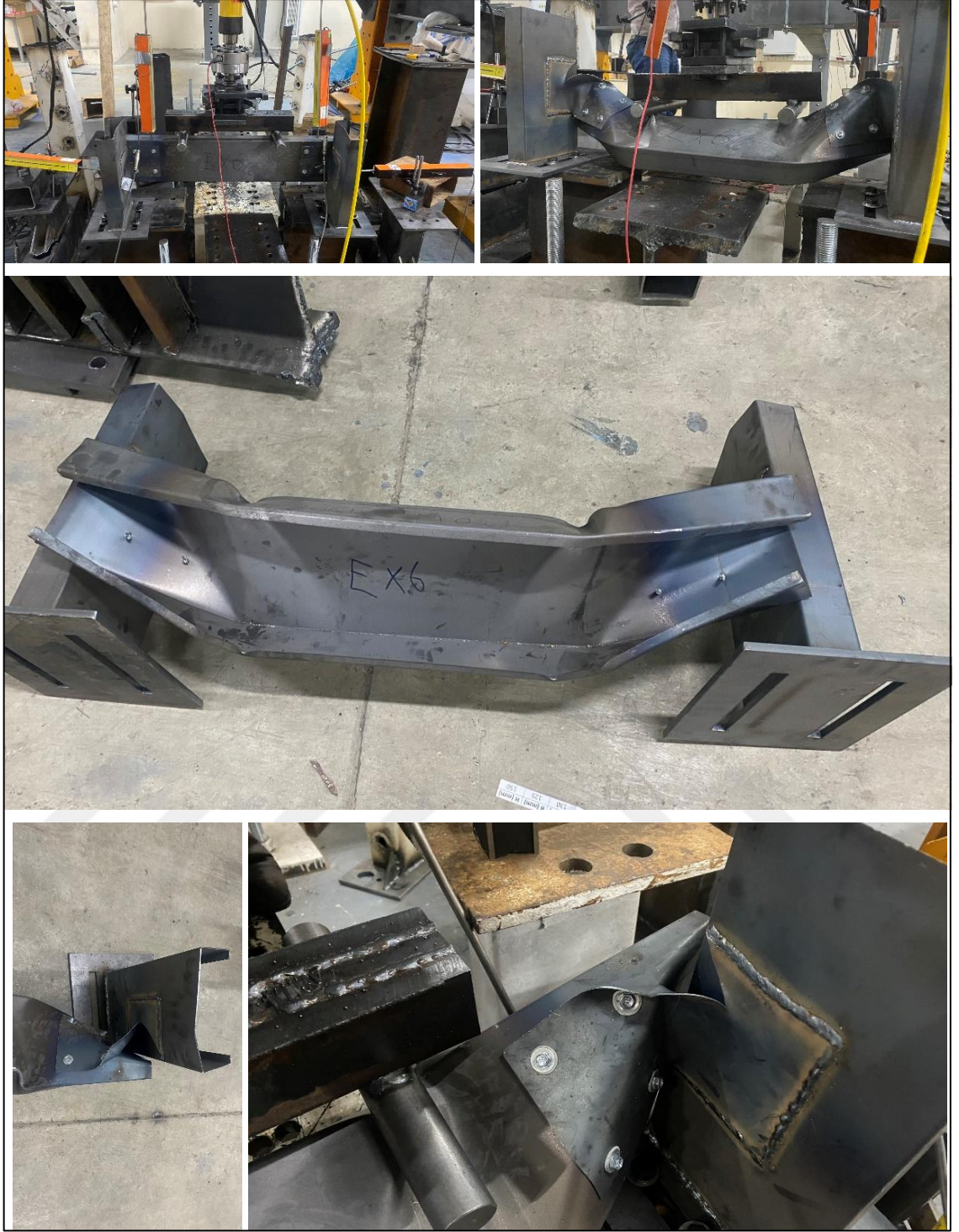
Şekil 4.20. EXP6-1,5-125-150 deney sonrası göçme görselleri
