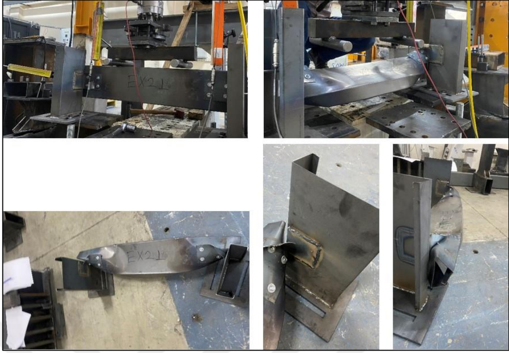
Şekil 4.15. EXP21-1,5-95-100 deney sonrası göçme görselleri
