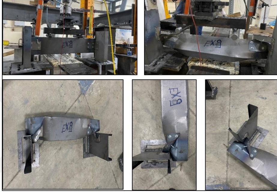
Şekil 4.2. EXP9-1,2-65-100 deney sonrası göçme görselleri
