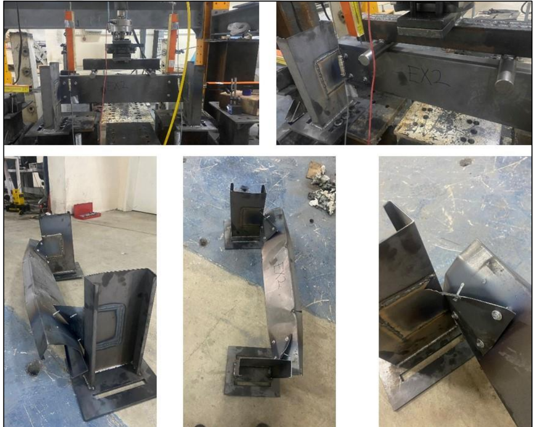
Şekil 4.8. EXP92-1,2-125-150 deney sonrası göçme görselleri
