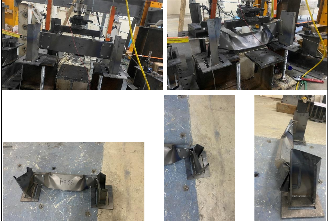
Şekil 4.46. EXP36-2,5-65-180 deney sonrası göçme görselleri
