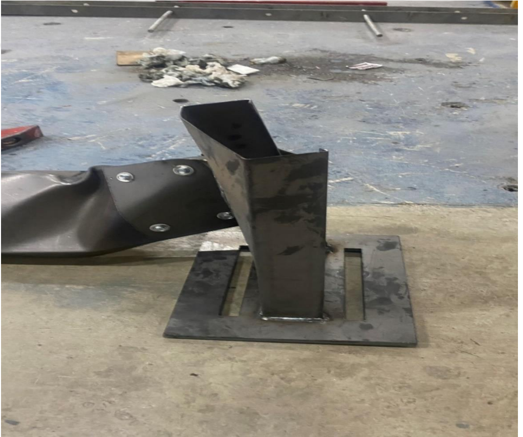
Şekil 4.71. Kolon burulmalı burkulma durumu
