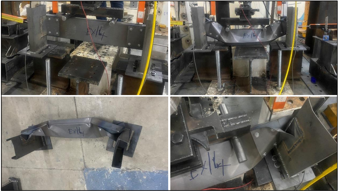
Şekil 4.11. EXP14-1,2-95-180 deney sonrası göçme modları
