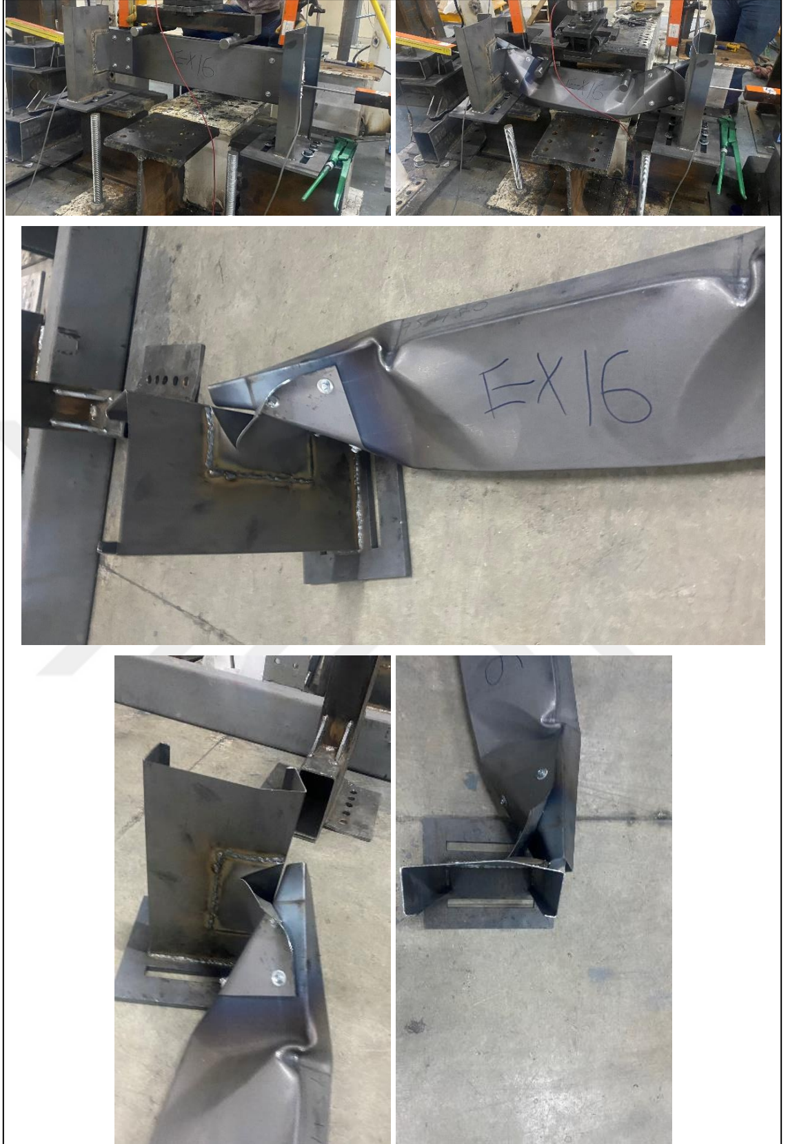
Şekil 4.23. EXP16-1,5-95-180 deney sonrası göçme görselleri
