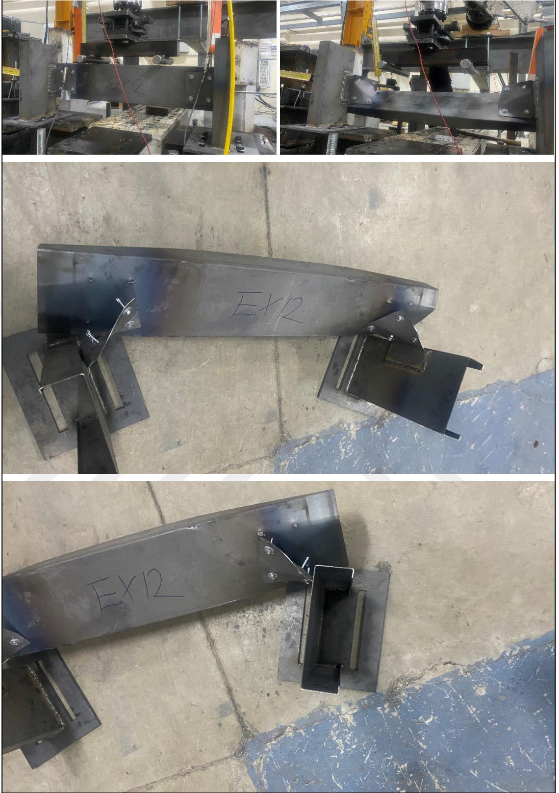
Şekil 4.18. EXP12-1,5-65-150 deney sonrası göçme görselleri
