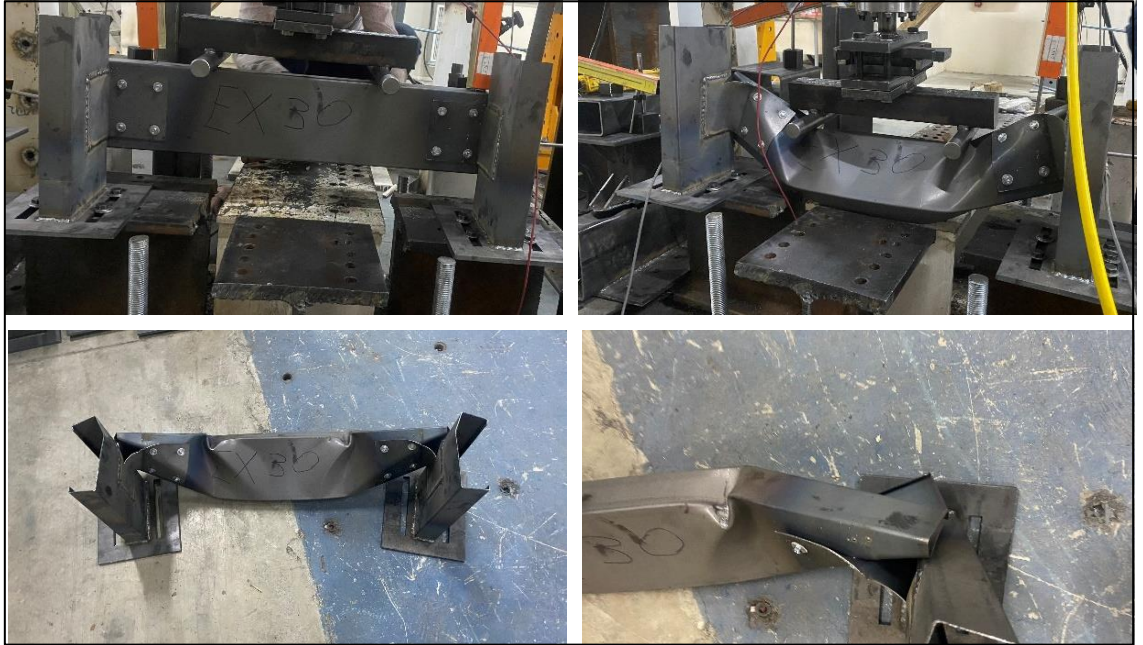
Şekil 4.32. EXP30-2-125-150 deney sonrası göçme görselleri
