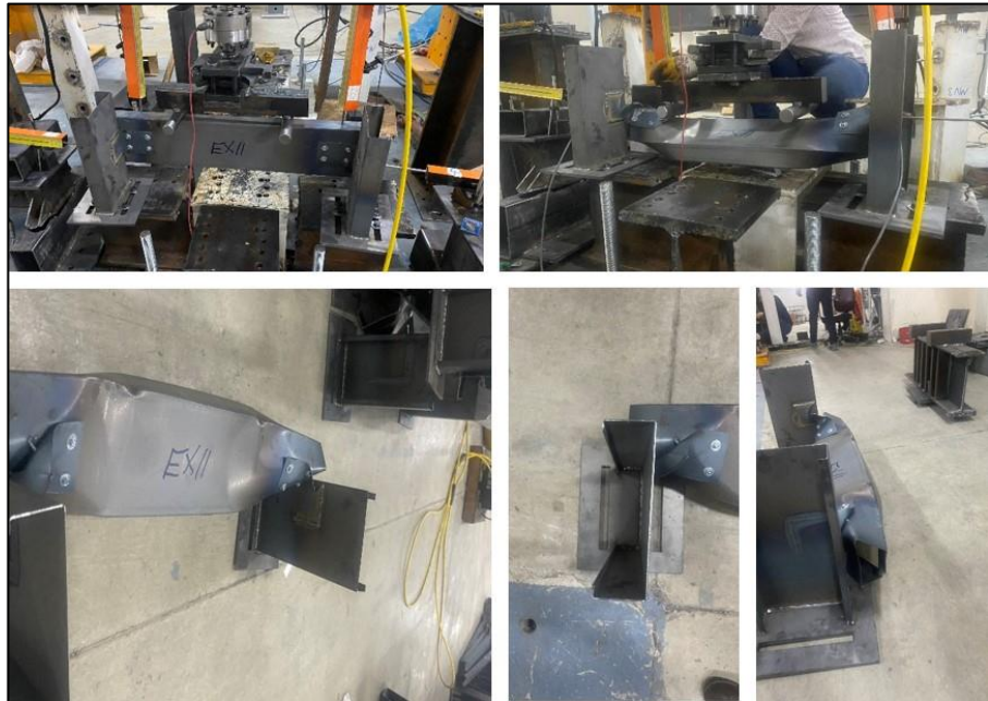
Şekil 4.3. EXP11-1,2-95-100 deney sonrası göçme görselleri
