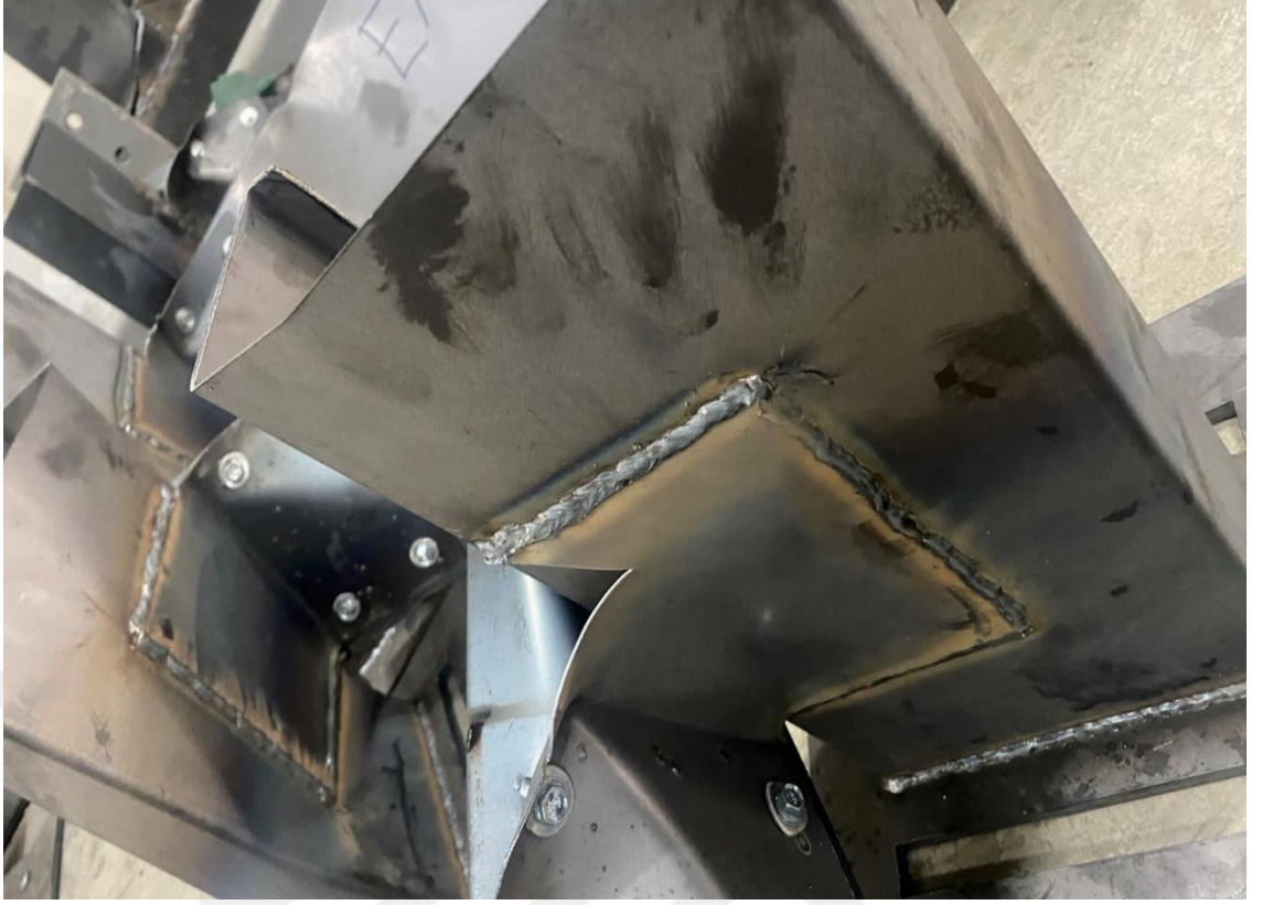
Şekil 4.74. Klips açısı yırtılması durumu
