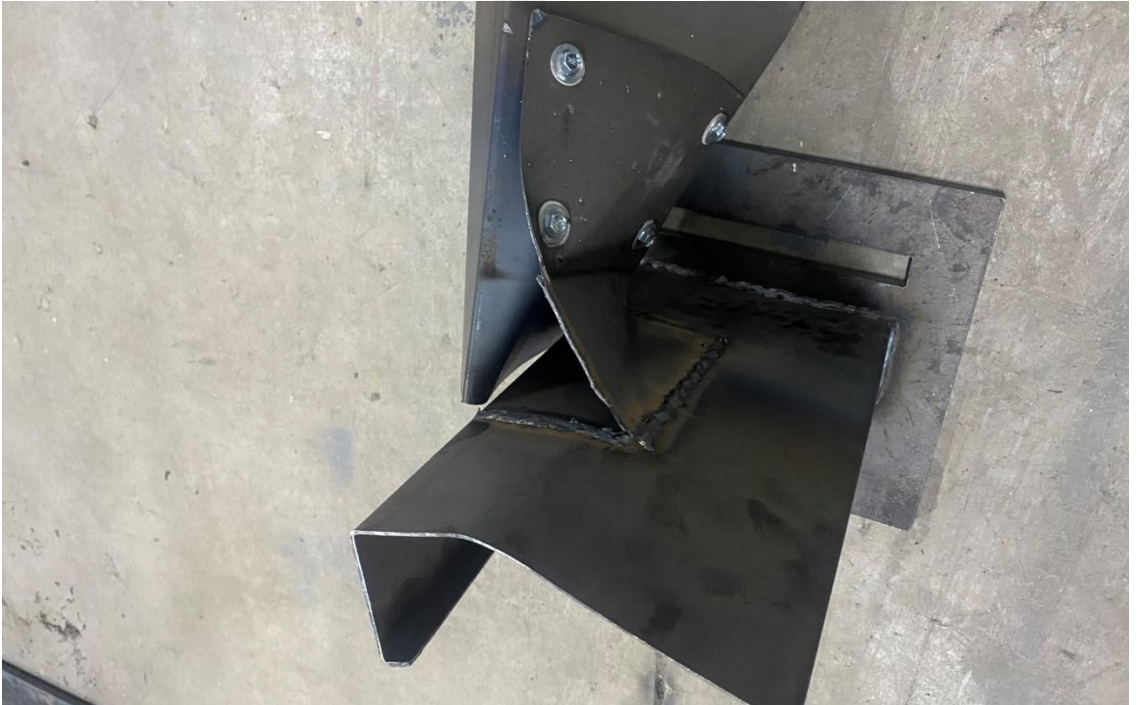
Şekil 4.75. Kolon distorsiyonal burkulması, klips açısı kaynak yırtılması ve giriş burkulması durumu.
