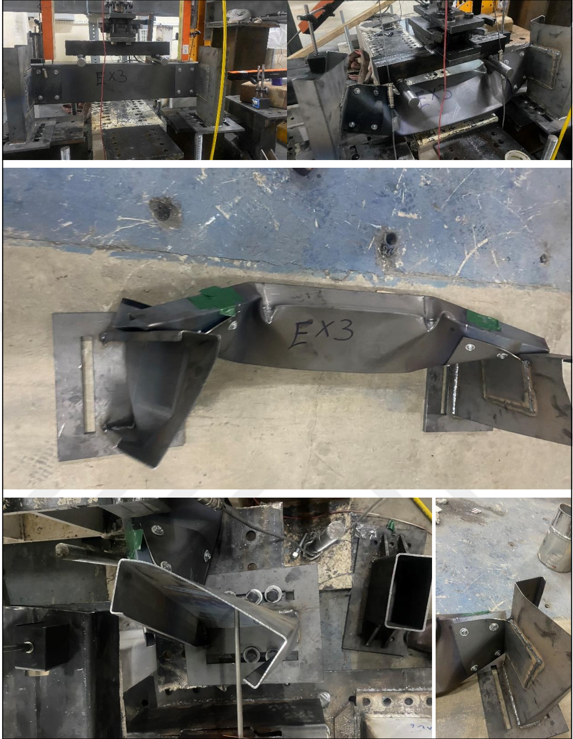
Şekil 4.48. EXP3-2,5-125-180 deney sonrası göçme görselleri
