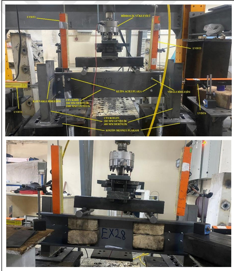
Şekil 3.17. Deney düzeneği sistemi
