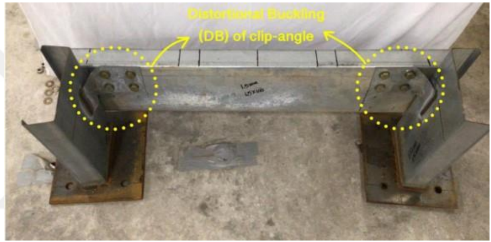
Şekil 2.16. Kanyaklı klips açıları distorsiyonel burkulması
