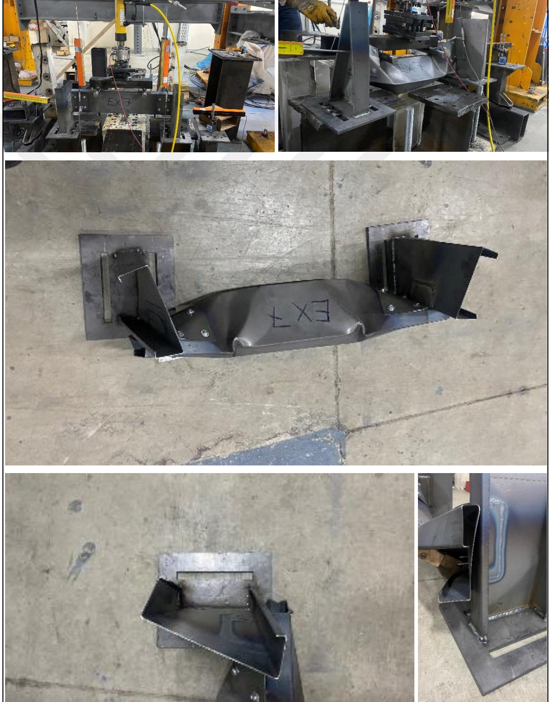
Şekil 4.42. EXP7-2,5-65-150 deney sonrası göçme görselleri
