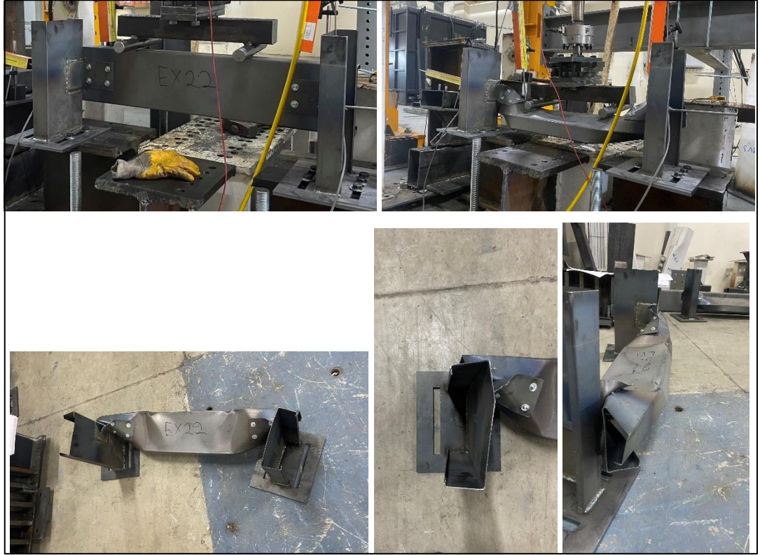
Şekil 4.27. EXP22-2-95-100 deney sonrası göçme görselleri
