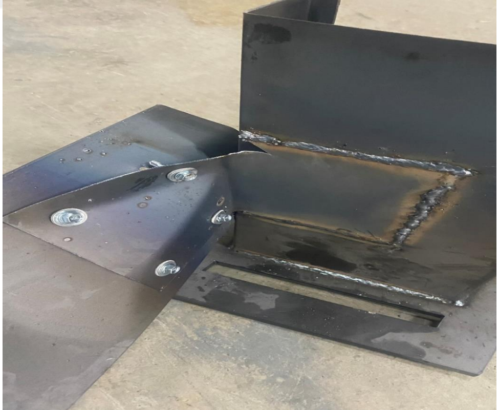
Şekil 4.69. Klips açısı yırtılması örneği
