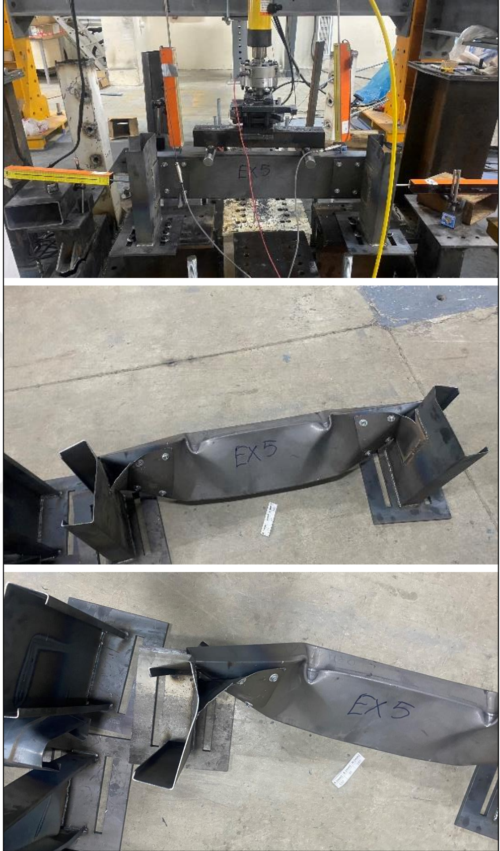
Şekil 4.35. EXP5-2-95-180 deney sonrası göçme görselleri
