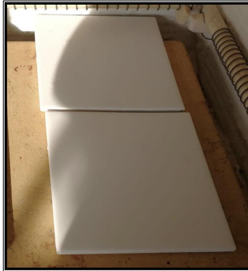
Resim 162 Kaymakam Sait Bey Çeşmesinin Güney Yönünde bulunan reproduksiyon karonun pişme aşaması(Burak ÜNER-20.12.2020-Bursa-İznik-TÜRKİYE)
