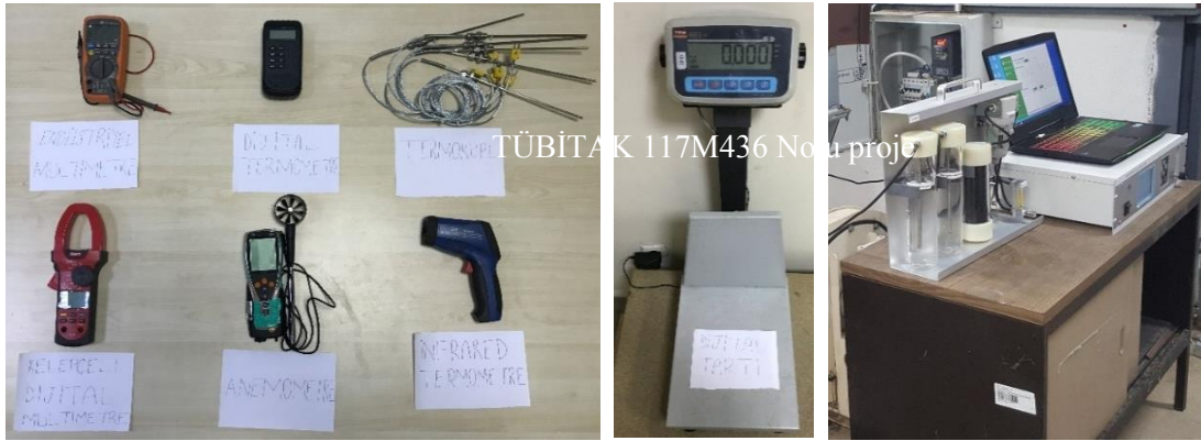
Şekil 5. Ark plazma gazlaştırma deneylerinde kullanılan manuel ölçüm cihazları
