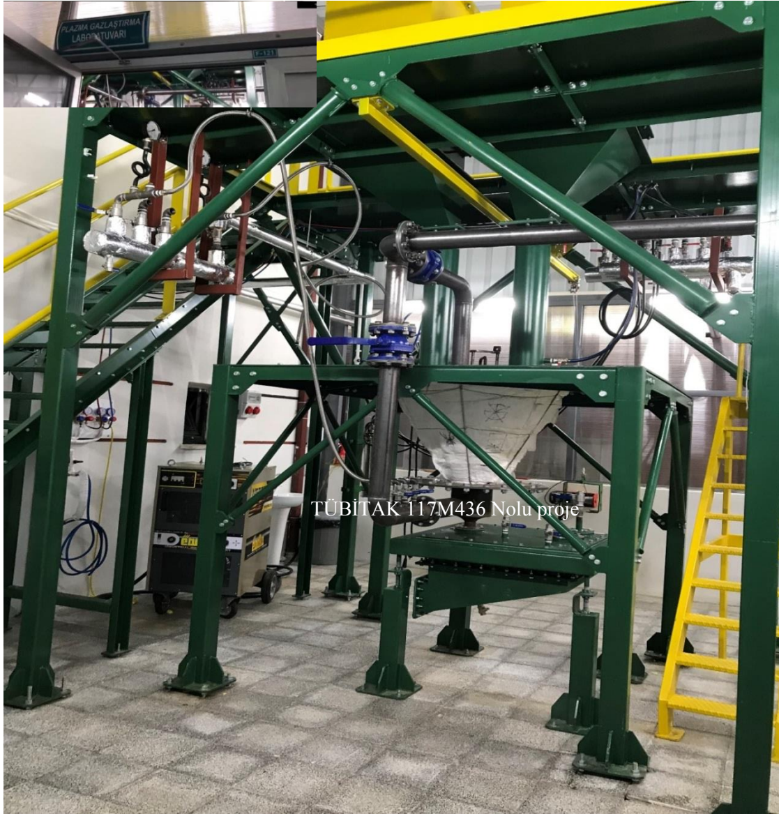
Şekil 3. Soğutma kolonlu arc plazma konik reaktörü
