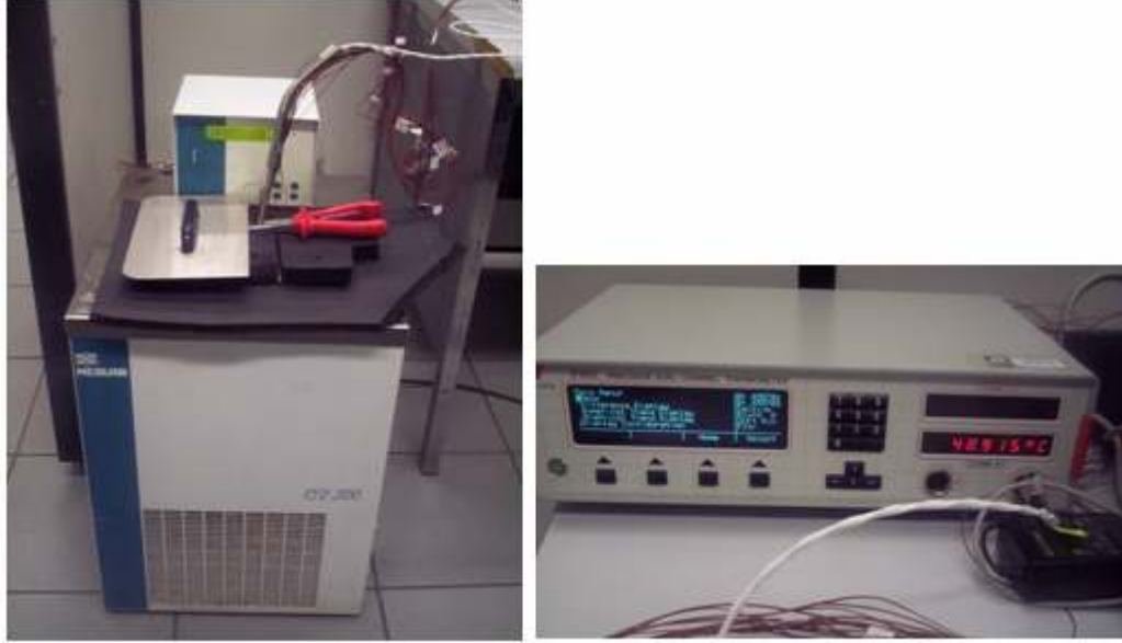
Şekil 5.9 Kalibrasyon su banyosu, referans termometre ve probunun yerleşimi
