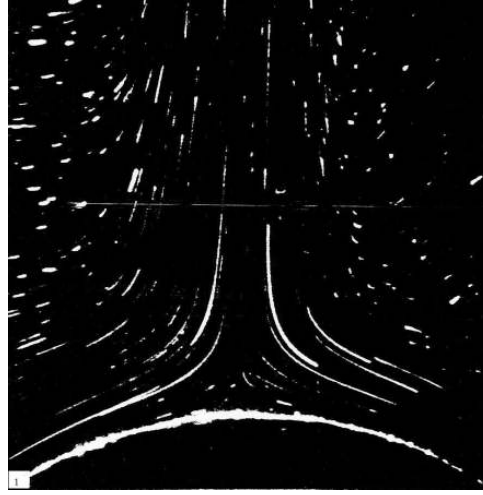
Şekil 2.5 Serbest taşınım şartlarında, ısıtılan yatay silindirik yüzeyde ve üzerinde oluşan akışın resmi (Pera ve Gebhart, 1971)
