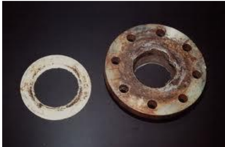
Şekil 2.4. Çatlak Korozyonu (Yadla vd. 2012)
