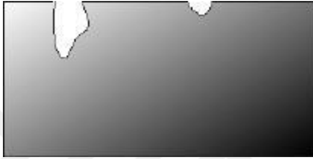
Şekil 2.3. Metalin Çukurlaşma Korozyonu (Yadla vd. 2012)
