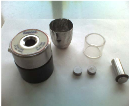
Şekil 3. 6. Numune hazırlama için kullanılan peletleme sistemi ve maksimum 15 ton kapasiteli presleme sistemi.
