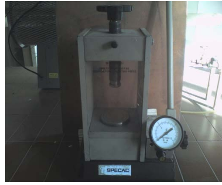
Şekil 3. 6. Numune hazırlama için kullanılan peletleme sistemi ve maksimum 15 ton kapasiteli presleme sistemi.
