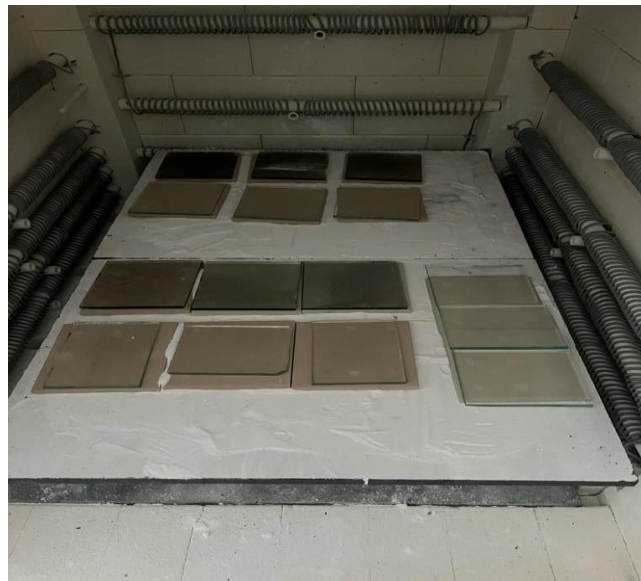
Şekil 3.9 Kaplanan camlara ısıl işlem uygulanması.
