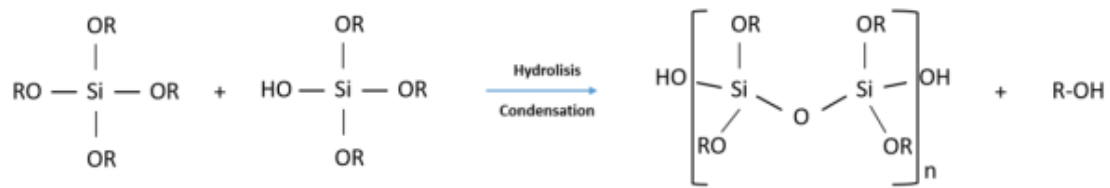
Şekil 2.6 Bir silis ağı oluşturmak için silikon alkoksitlerin reaksiyonu R=alkoksi.
