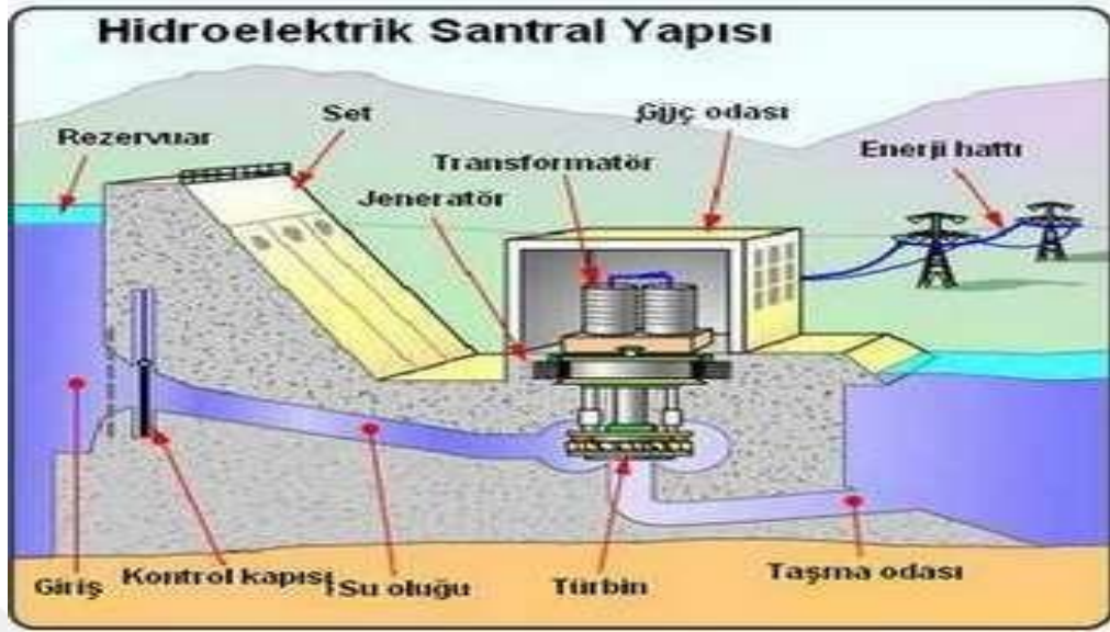
Şekil 8. Barajlı (depolamalı-biriktirmeli) hidroelektrik santraller.
