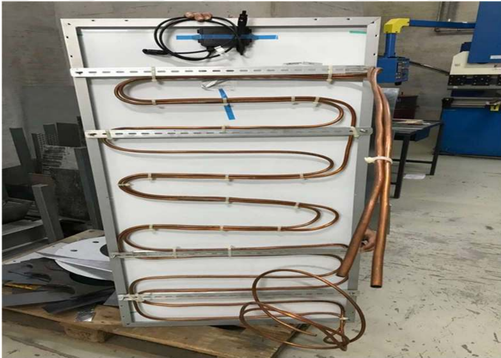
Şekil 5.4 Bakır Borunun Panelin Arka Kısımına Montajı
