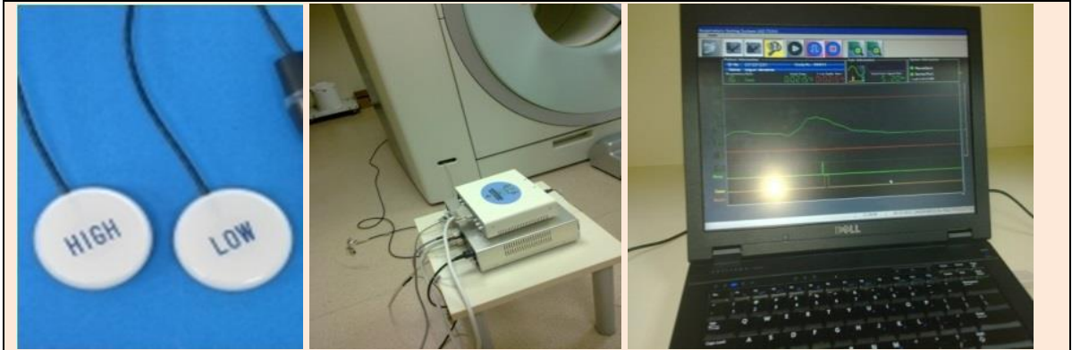
Şekil 2.9 Anzai 733 marka solunum kapılama cihazı ve aksesuarları
