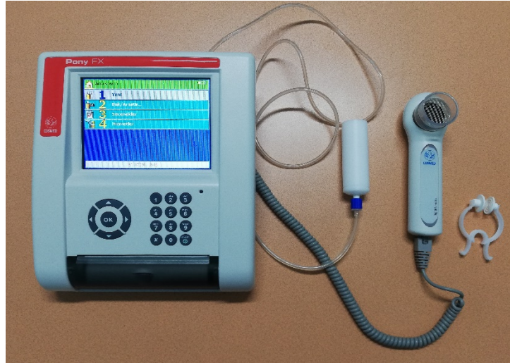
Şekil 7: SFT ve MIP-MEP ölçümlerinin yapıldığı 'Cosmed® Pony FX Spirometer (Italy)' model ölçüm cihazı
