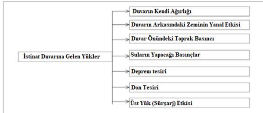
Şekil 1.16. İstinat duvarlarına gelen yükler (Güliden 2014)
