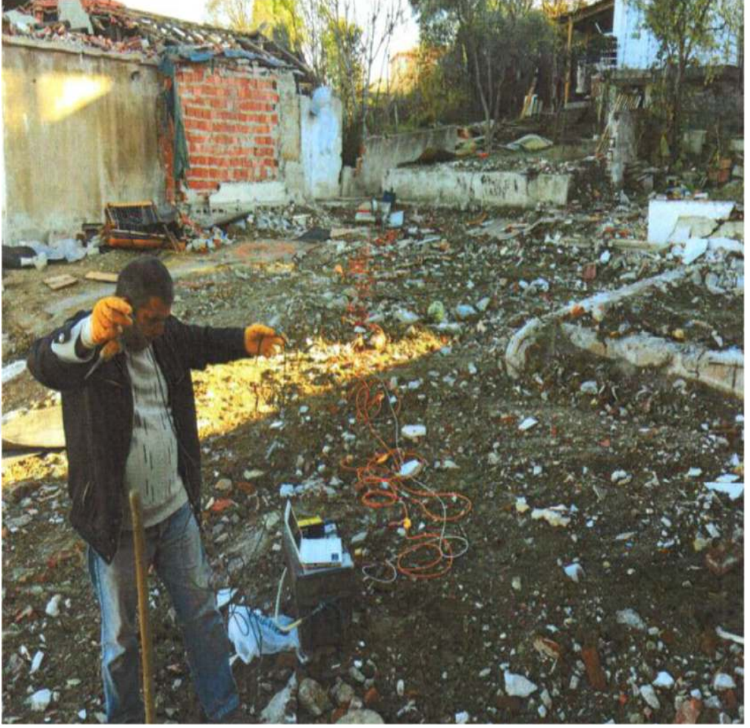
Şekil 6.1. Arazide yapılan sismik kırılma çalışması.
