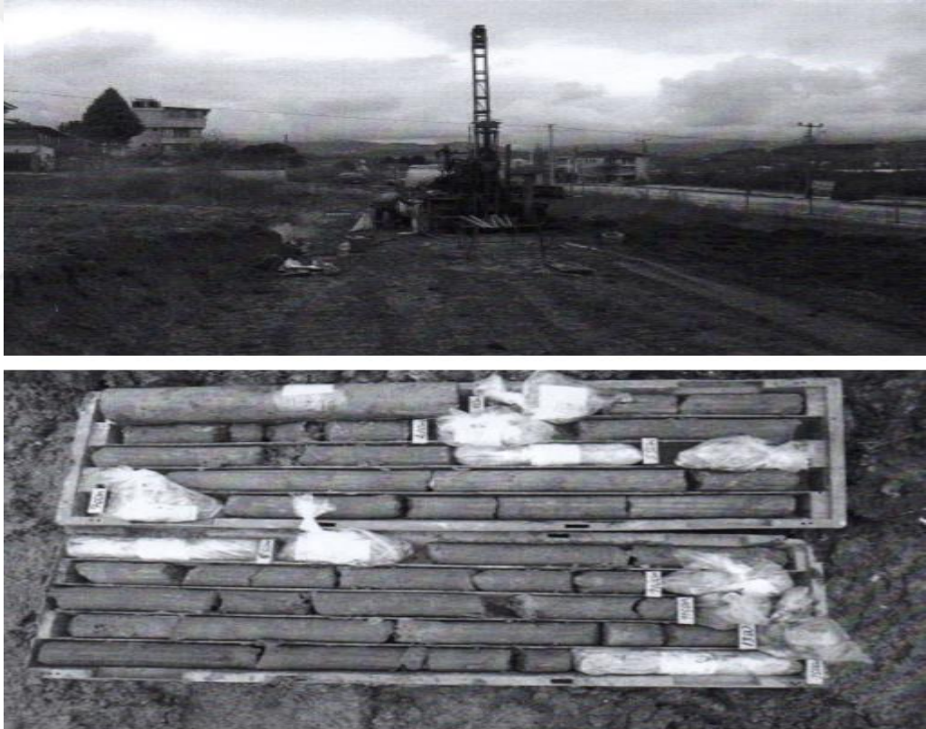
Şekil 6.1. Sondaj çalışmalarında alınan karotlar (Akbaş, 2018).
