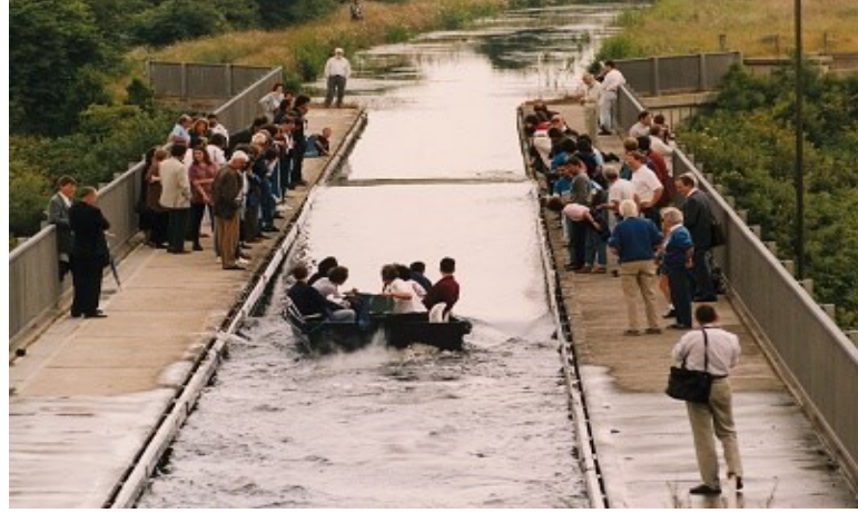
Şekil 2.2: Union Kanal'daki su kemeri üzerinde soliter dalga inşası.
