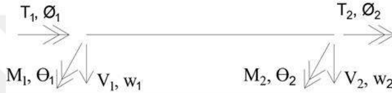
Şekil 3.6 Elastik zemine oturan kiriş elemanın statik serbestlikleri
