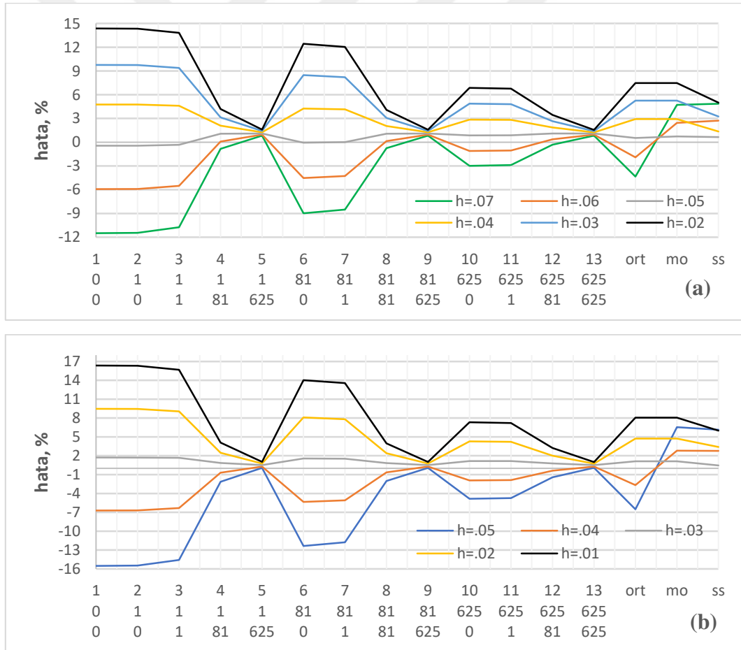
Şekil 3.23 v=0.2 için hata oranları (%), (a) n=10 \times 10 , (b) n=16 \times 16
