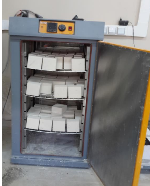
Şekil 3-19 Yıkanan Bayburt Taşlarının Etüvde Kurutulması
