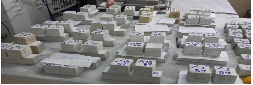
Şekil 3-13 Sönmüş kireç harçlarının havada küre bırakılması
