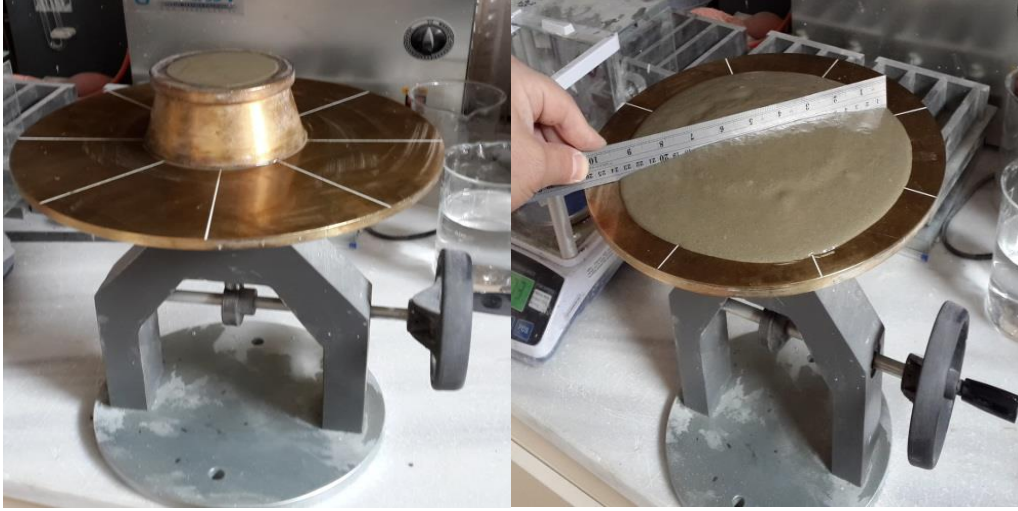
Şekil 3-17 Yayılma Tablası ve Ölçüm Şekli
