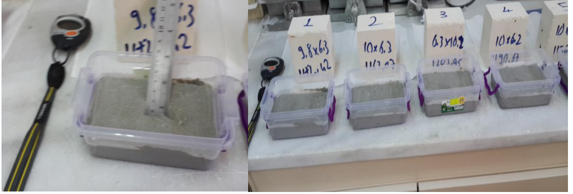
Şekil 3-18 Harç kalınlığı ölçümü ve deney kaplarının hazırlanışı
