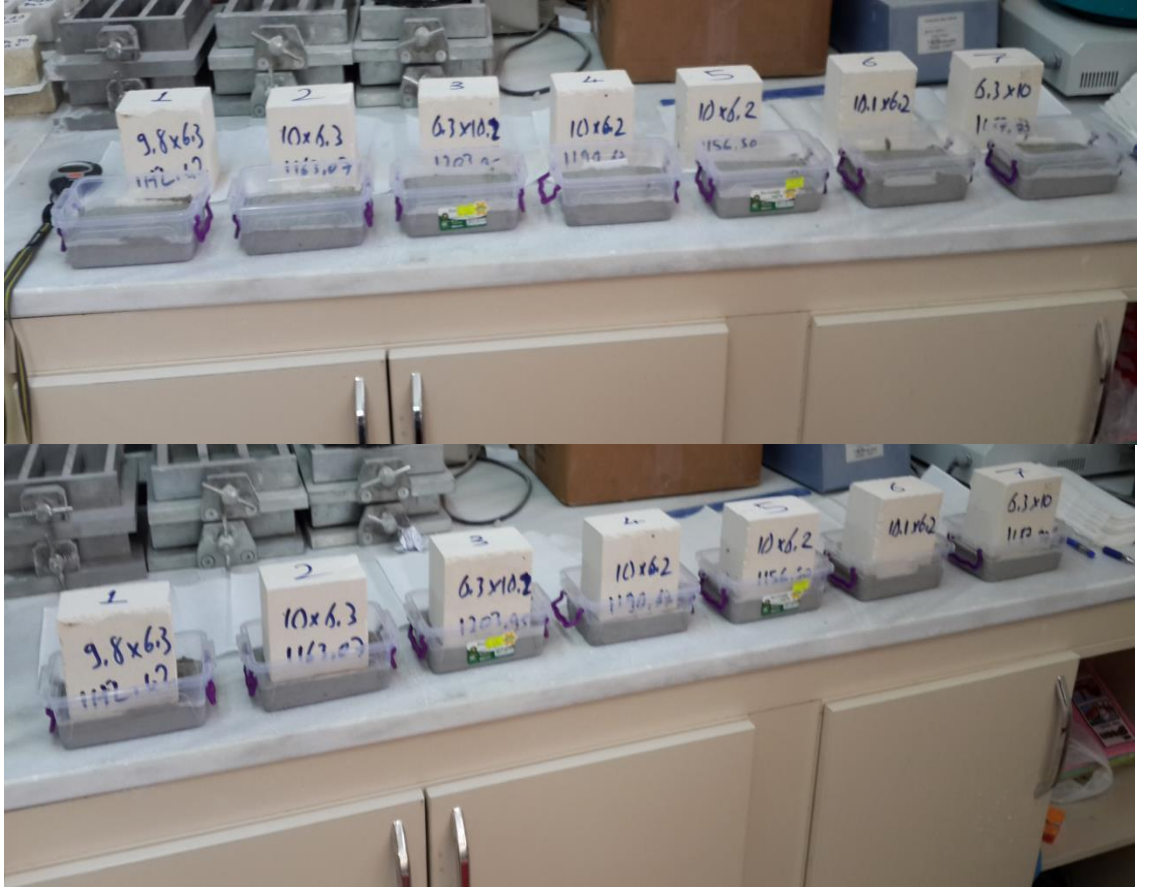
Şekil 3-22 Harcın Su İletme Kapasitesi ve Süresi Deneyi
