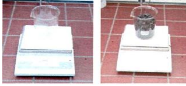
Şekil 29. SMA karışımının hazırlanması ve cam beherin boş ve karışım dolu tartımı
