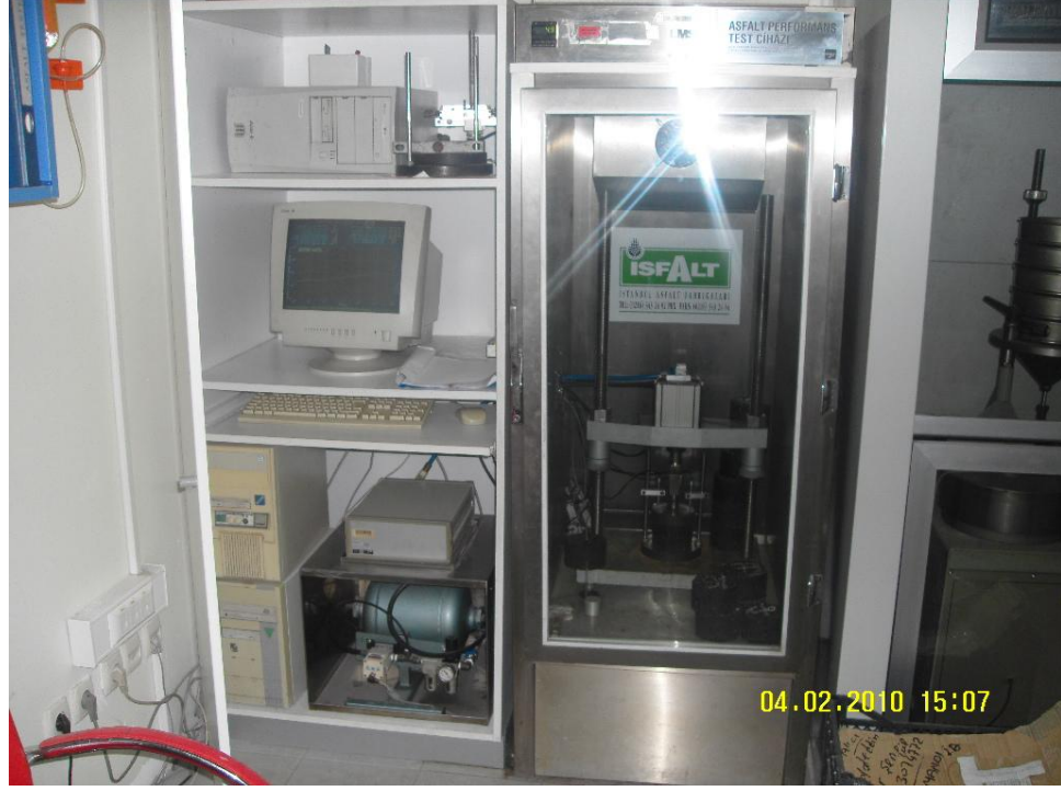
Şekil 35. Sünme deneylerinin yapıldığı cihaz ile test düzeneği
