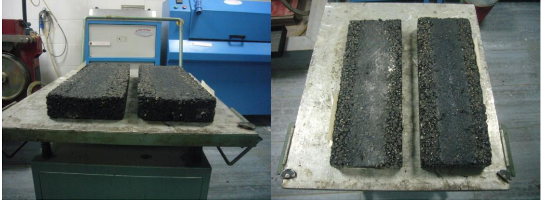
Şekil 40. Tekerlek izi deneyi sonrası slablardan görünüm
